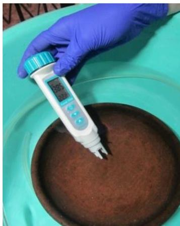
Foto 41: Medición de conductividad y total de sólidos disueltos en solución
