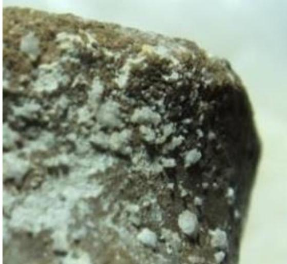
Foto 38: Botella Miniatura ID 1097 a través de macroscopía óptica que detalla la cubierta pulverienta provocada por el afloramiento de sales.
