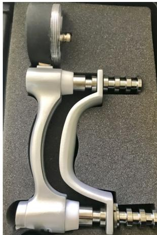
**Figura 2.** Dinamómetro Jamar en posición II.
