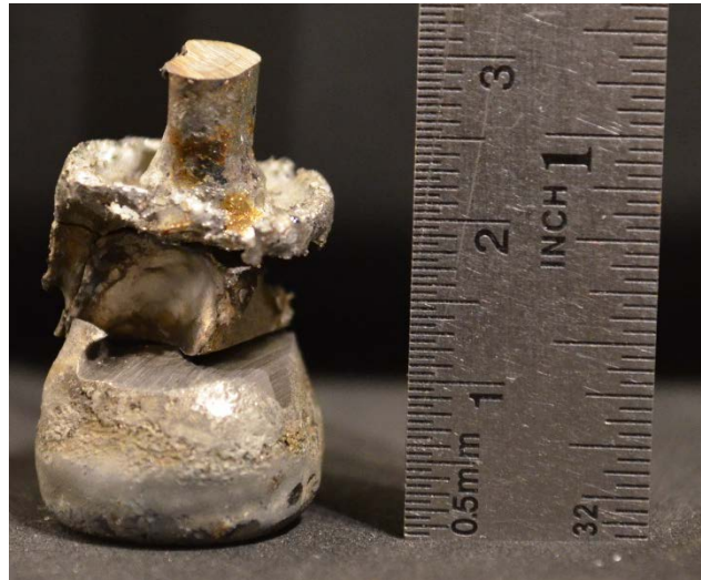
Figura 32 Perfil Longitudinal Frontal, Recipiente de Acero. T=1.400°C, P=70 MPa, t=30 min.
