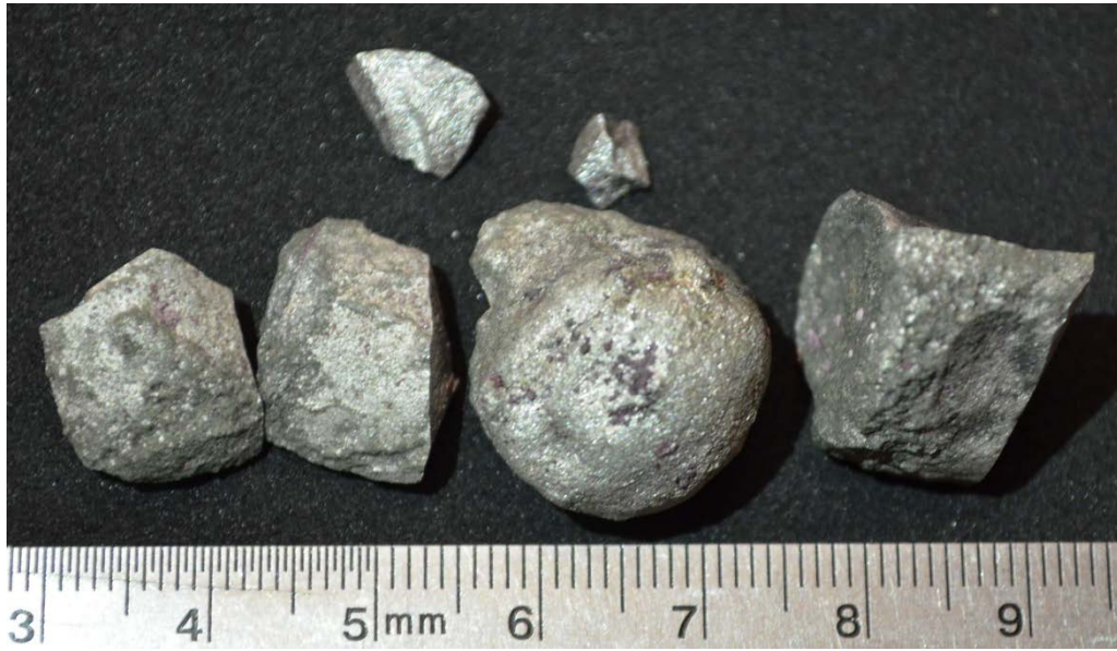
Figura 56 Detalle superficial de la muestra. T=1.400°C, P=70 MPa, t=120 min.
