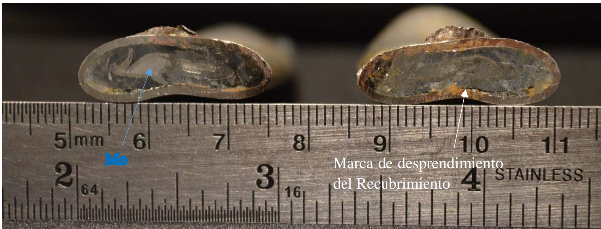
Figura 18 Recipiente de Acero con recubrimiento interno vítreo, Sección B-B. T=1.200^{\circ}\text{C} , P=70\text{ MPa} , t=120\text{ min} .
