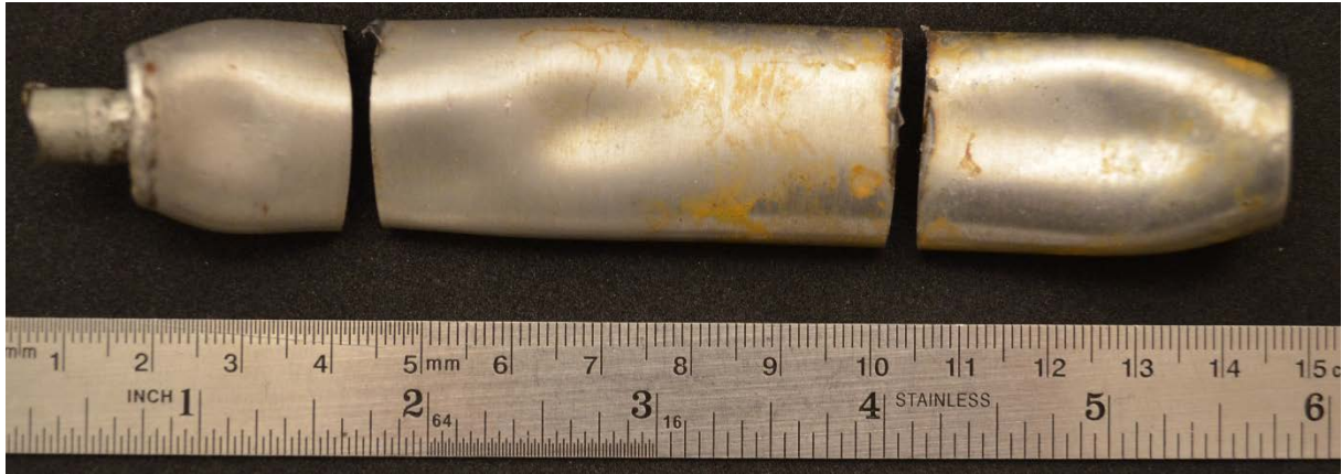
Figura 15 Perfil Longitudinal Frontal del Recipiente de Acero con recubrimiento interno vítreo. T= 1.200°C, P=70 MPa, h=120 min.
