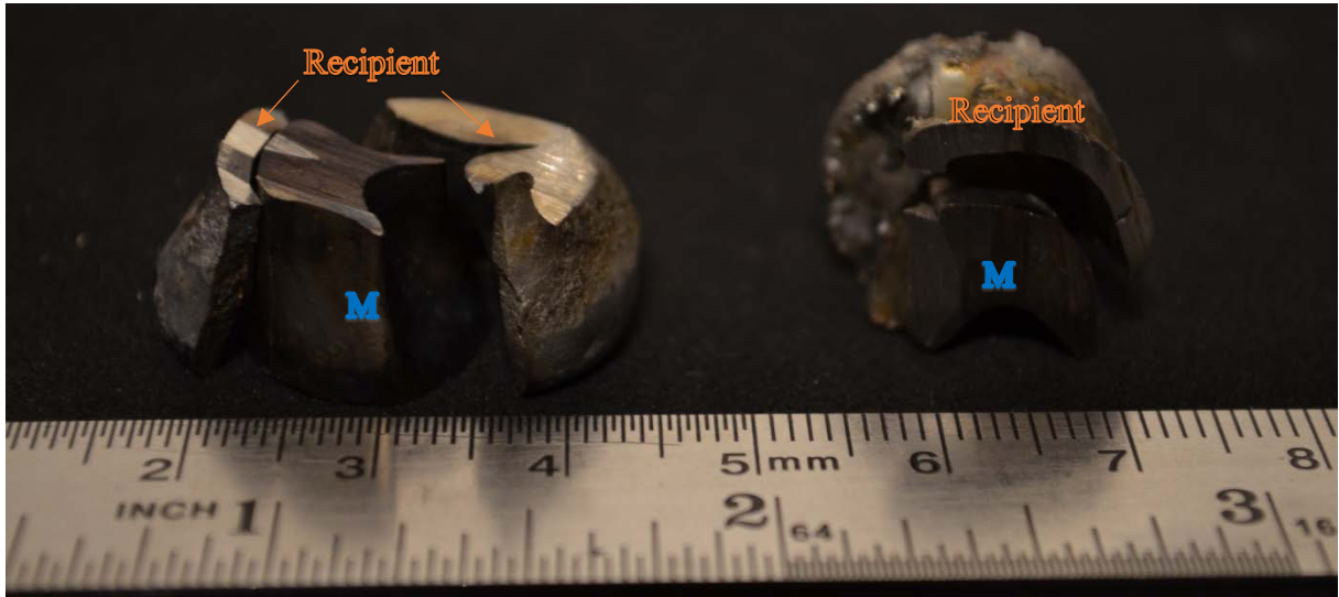
Figura 36 Secciones de la muestra. T=1.400^{\circ}\text{C} , P=70\text{ MPa} , t=30\text{ min} .
