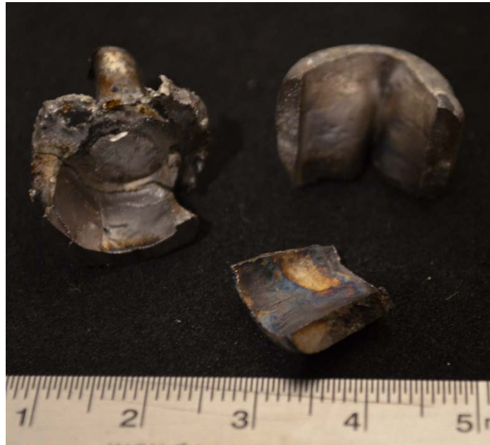
Figura 34 Partes del recipiente de acero. T=1.400^{\circ}\text{C} , P=70\text{ MPa} , t=30\text{ min} .
