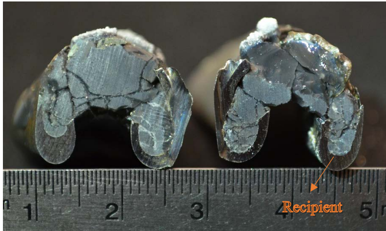
Figura 49 Recipiente de Acero con recubrimiento interno vítreo, Sección E-E. T=1.400°C, P=70 MPa, t=120 min.
