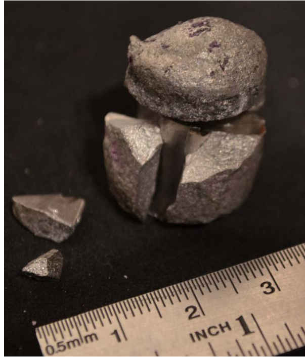
Figura 54 Perfil Longitudinal frontal. Recipiente de Acero. T=1.400^{\circ}\text{C} , P=70\text{ MPa} , t=120\text{ min} .
