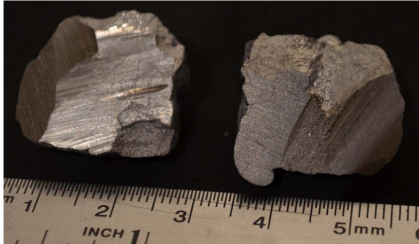
Figura 43 Sección transversal de la muestra del recipiente de acero. T=1.400^{\circ}\text{C} , P=10\text{ MPa} , t=120\text{ min} .
