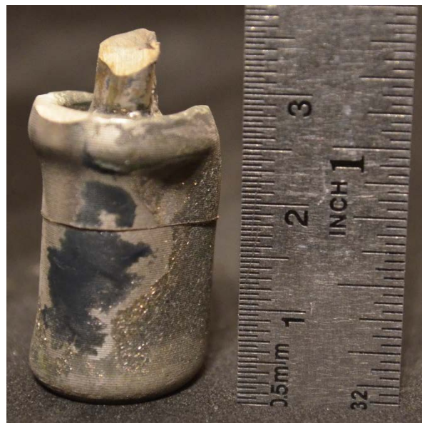
Figura 23 Perfil Longitudinal, Recipiente de Acero. T=1.200^{\circ}\text{C} , P=70\text{ MPa} , t=120\text{ min} .
