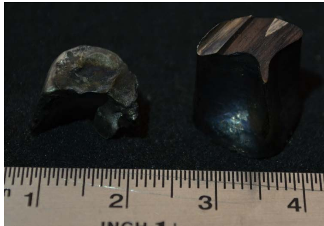
Figura 35 Partes de Mo obtenido. T=1.400^{\circ}\text{C} , P=70\text{ MPa} , t=30\text{ min} .
