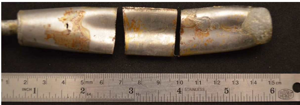
Figura 28 Perfil Longitudinal Posterior del Recipiente de Acero con recubrimiento interno vítreo. T= 1.400°C, P=70 MPa, t=30 min.
