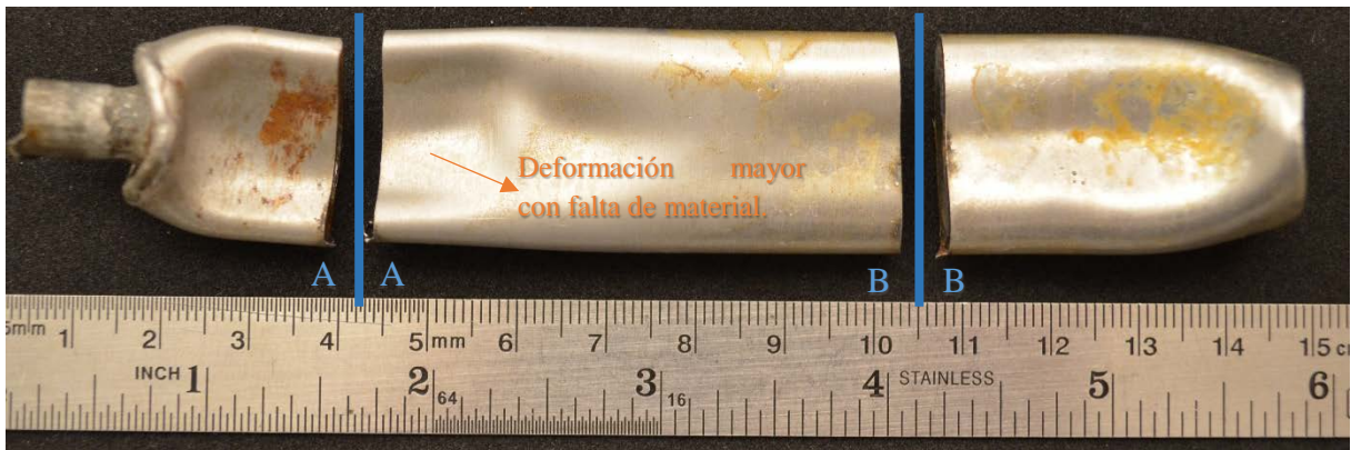
Figura 16 Perfil Longitudinal Posterior del Recipiente de Acero con recubrimiento interno vítreo. Sección A-A, Sección B-B. T= 1.200°C, P=70 MPa, t=120 min.
