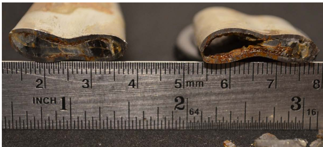
Figura 30 Recipiente de Acero con recubrimiento interno vítreo, Sección D-D. T= 1.400°C, P=70 MPa, t=30 min.
