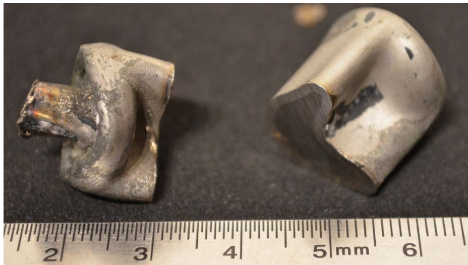
Figura 22 Recipiente de Acero. T=1.200^{\circ}\text{C} , P=70\text{ MPa} , t=120\text{ min} .
