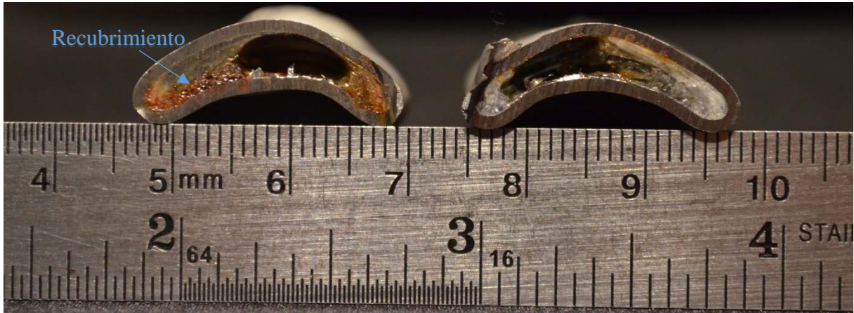
Figura 17 Recipiente de Acero con recubrimiento interno vítreo, Sección A-A. T=1.200^{\circ}\text{C} , P=70\text{ MPa} , t=120\text{ min} .
