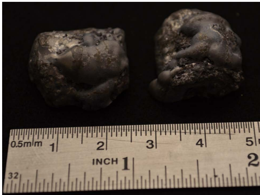
Figura 44 Superficie de la muestra del recipiente de acero. T=1.400^{\circ}\text{C} , P=10\text{ MPa} , t=120\text{ min} .
