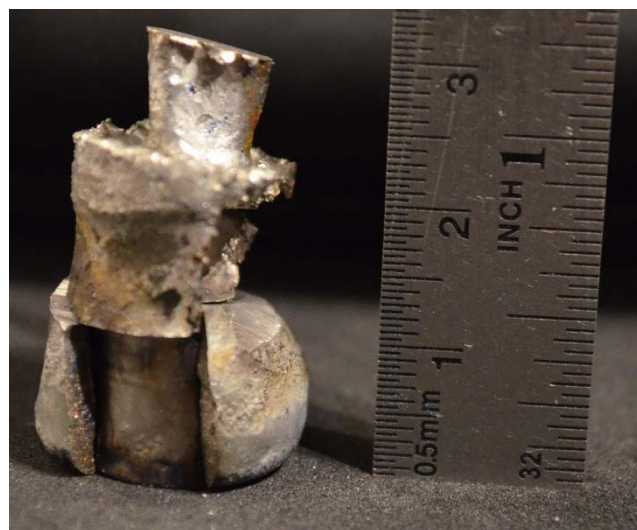
Figura 33 Perfil Longitudinal Posterior, Recipiente de Acero. T=1.400°C, P=70 MPa, t=30 min.
