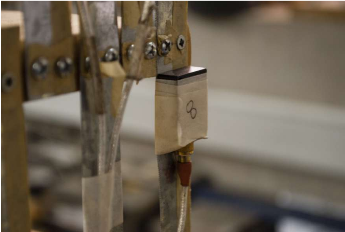
Figura 3.8: Fotografía del montaje de un acelerómetro a la estructura 2
