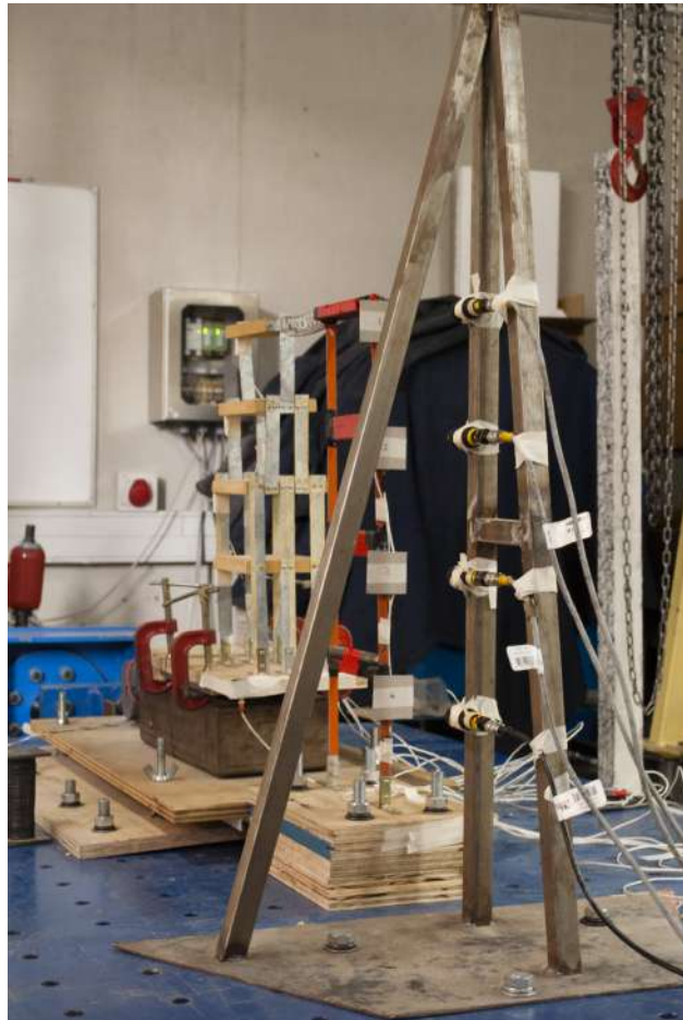
Figura 3.7: Fotografía del montaje de los sensores ultrasónicos en la estructura metálica
