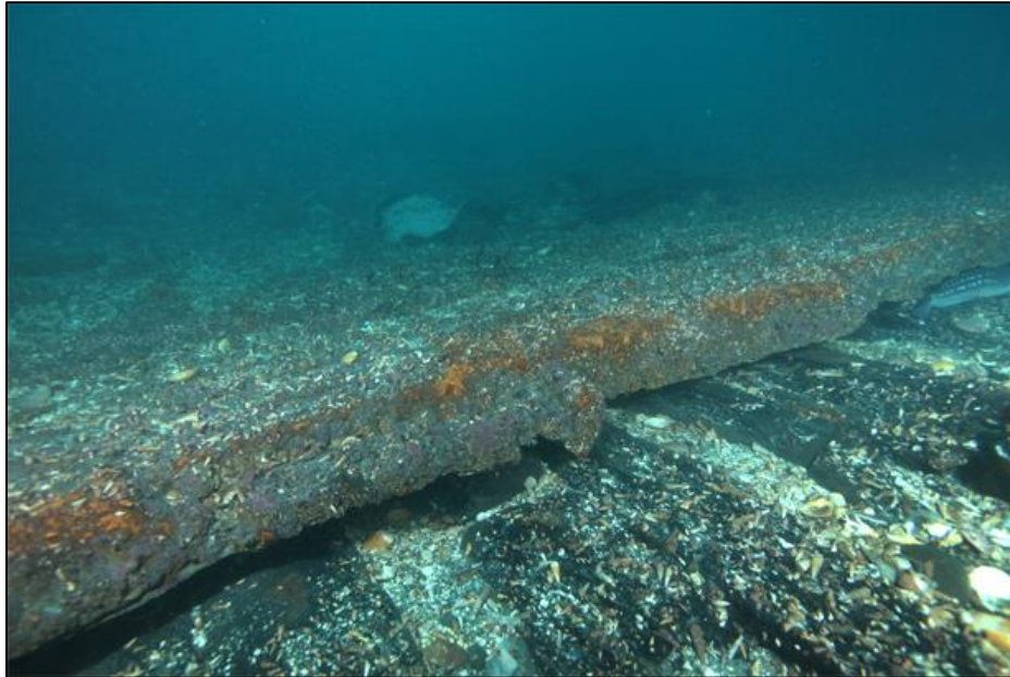
Figura 3-12. Vista de la estructura del sector A, en dirección SW. Corresponde a la mitad de estribor del buque, la que se halla más expuesta. Se observa parte del lastre permanente formado por lingotes dispuesto en forma longitudinal, el que se ha concretado formando un conglomerado. Más abajo, en forma transversal, se observan las cuadernas dobles. El forro interior, entre ambos, se ha desintegrado.
