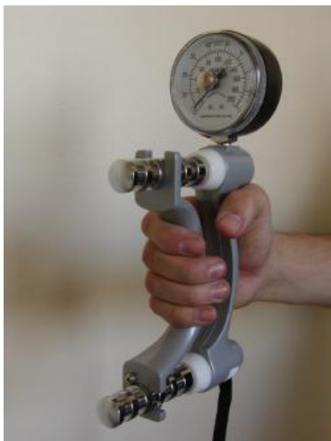
Imagen 5: Dinamómetro homologado JAMAR (Jamar TM Hidraulic Pinch Gauge, Therapeutic Equipment Corporation, Clifton, New Jersey, EEUU) para medir fuerza de pinza lateral y tridigital.
