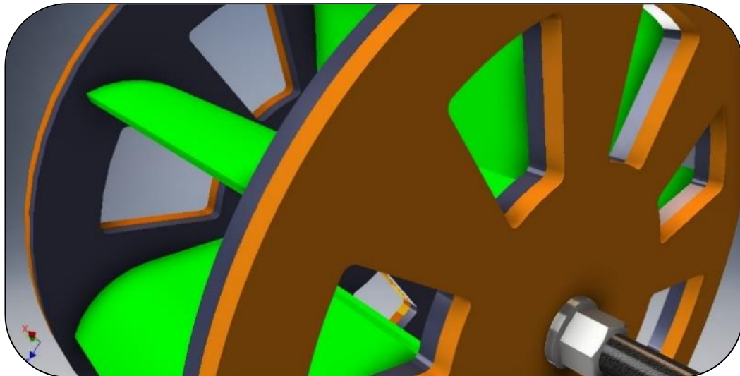
Figura 1.3 "Acercamiento a diseño preliminar de turbina en software CAD"
