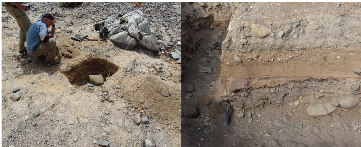
Figura 15. Excavación de calicatas (izquierda) y trincheras (derecha).
