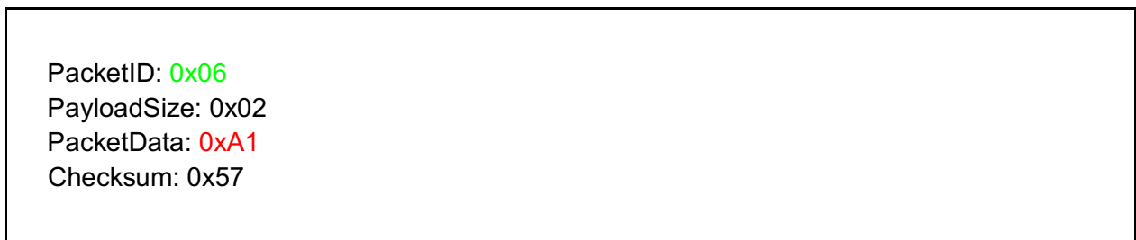
Figura 2.7: Respuesta a instrucción para habilitar interfaz FMI en formato binario. (Imagen de autoría propia).
