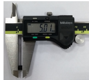
(c) Medición de la altura después del limado.
