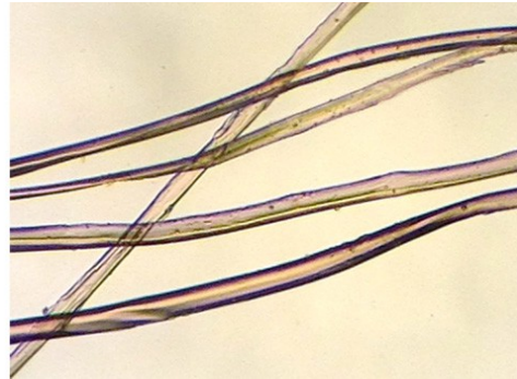
Fig. 73-74. Corte transversal y longitudinal de la urdimbre del terciopelo.
