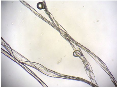
Fig. 18-19. Corte longitudinal y transversal de fibra de la urdimbre.
