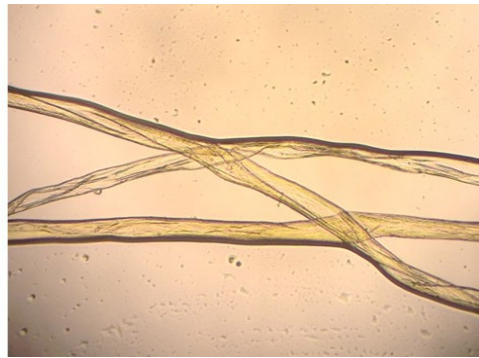
Fig. 81-82. Corte transversal y longitudinal del hilo de costura.
