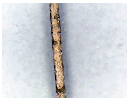
Fig. 103. Muestra de hilo metálico de bordados después de eliminada la capa de plata.
