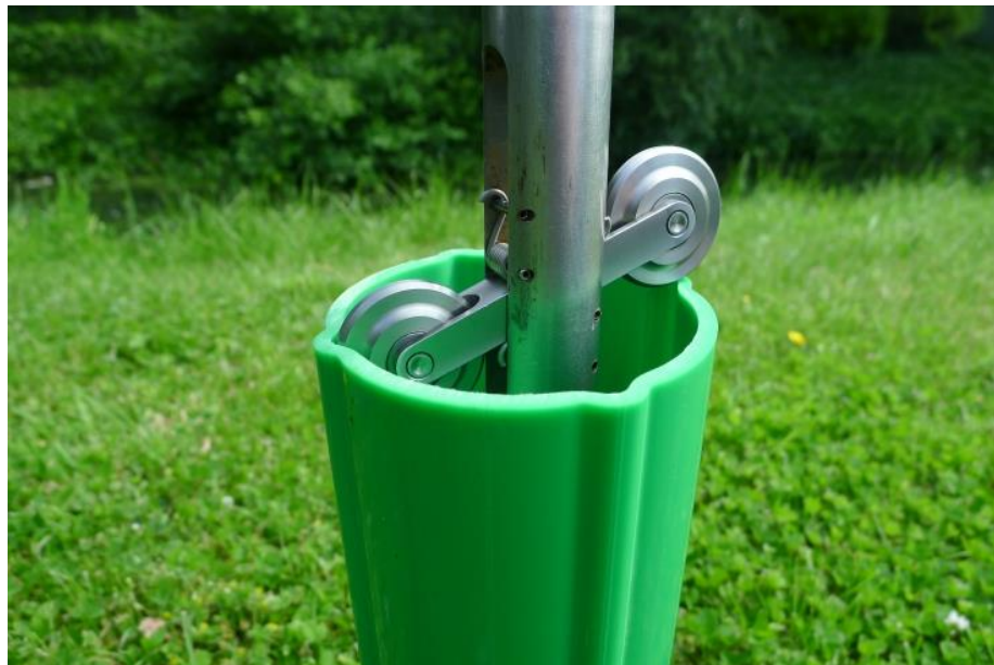
Figura 4.2 Tubería de la sonda inclinométrica.
