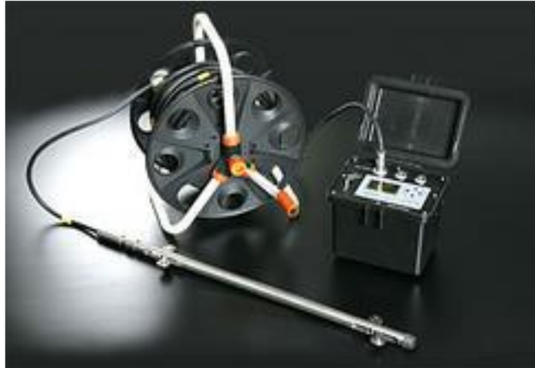
Figura 4.1 Conjunto de inclinómetro, cable y unidad de lectura.
