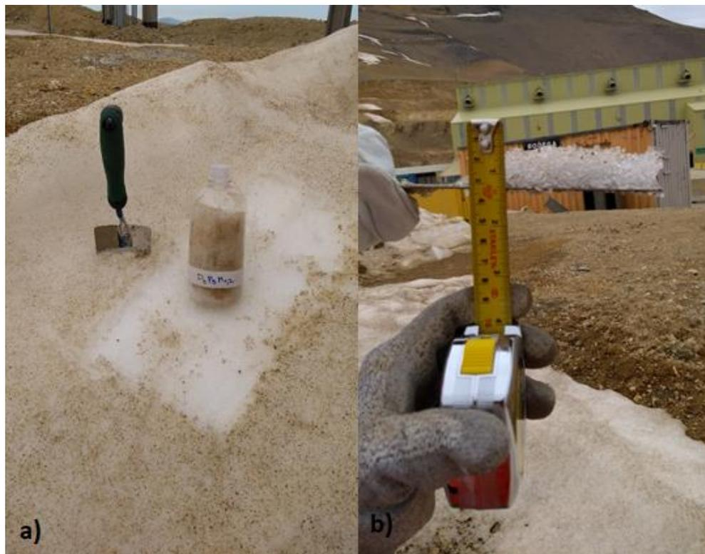
Imagen 5: a) Panel de nieve retirado y su muestra correspondiente, punto de control Joachim. b) Fotografía del espesor de manto retirado para el estudio isotópico de muestras tipo S (2cm. Aprox.).
