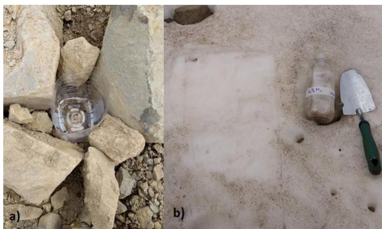
Imagen 7: a) Fotografía del colector instalado para capturar nieve fresca. b) Panel de nieve retirada y su muestra correspondiente, punto de control QC.
