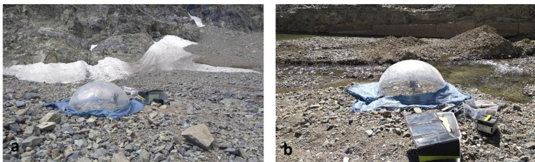
Figura 1.7.8: Domo de acrílico utilizado para medir flujo de evaporación durante la campaña. a) Punto de control cabecera de la quebrada Teniente. b) Punto de control quebrada Coya.
