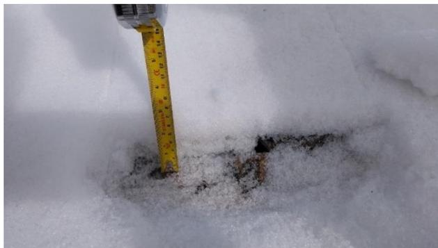
Imagen 17: Espesor del manto de nieve en la estación del Adit 42.
