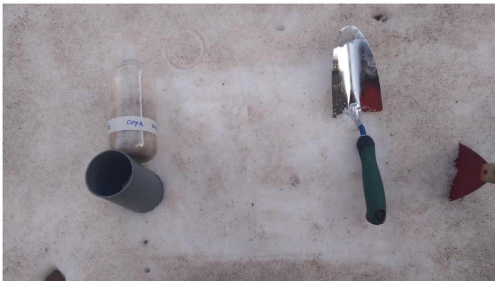
Imagen 19: Colector de testigos de nieve, muestra de nieve y el panel del cual se extrajo ésta.
