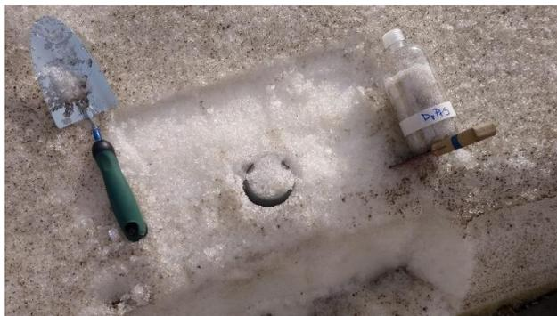
Imagen 18: Colector de testigos, el panel del cual se extrajo el material y un testigo de nieve antes de ser extraído.
