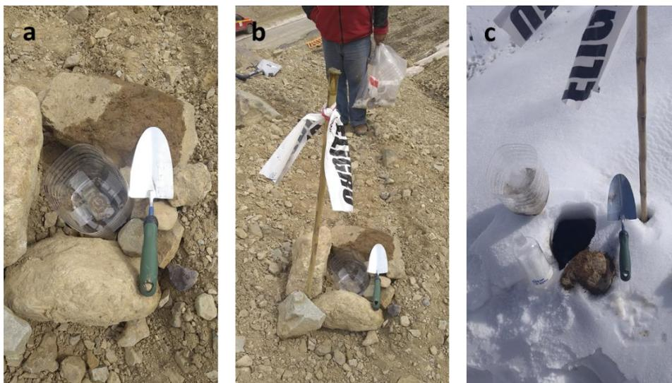
Figura 1.7.2: (a) y (b) Colector para nieve fresca instalado en el punto de control Curva del Espejo. (c) Fotografía tomada después del primer evento de precipitación muestreado, en el que se retiró el colector a partir del cual se extrajo la muestra.
