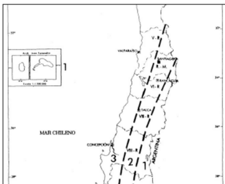
Figura 3.4: Zonas sísmicas de subducción según la norma NCH 433, Of. 96
