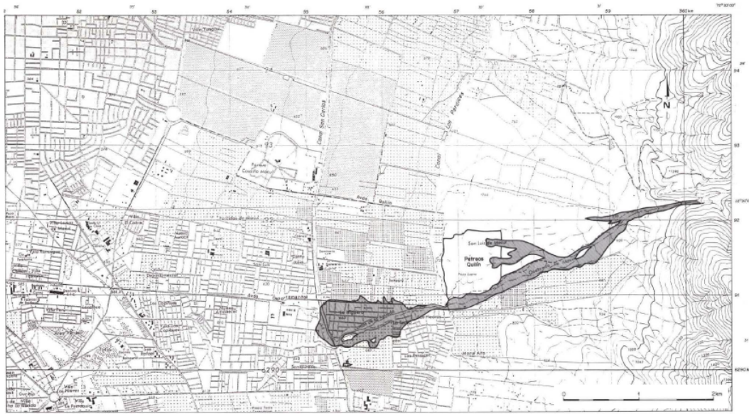
Figura 5.2: Distribución generalizada del flujo de detritos de la Quebrada de Macul. Extraído de Naranjo y Varela (1996).
