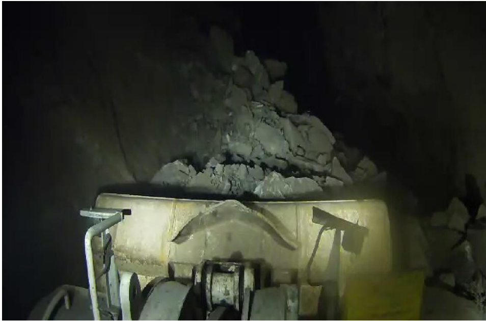
FIGURA 21: BALDE CARGADO RESULTANTE DE LA CARGA AUTÓNOMA EN CASERÓN.
