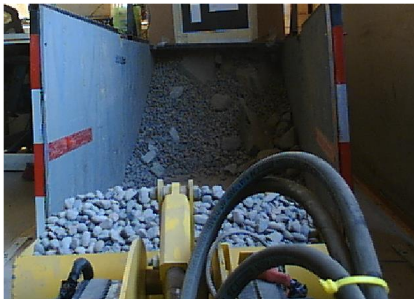
FIGURA 7: RESULTADO DE CARGA TELEOPERADA PARA PROTOTIPO DE LABORATORIO.
