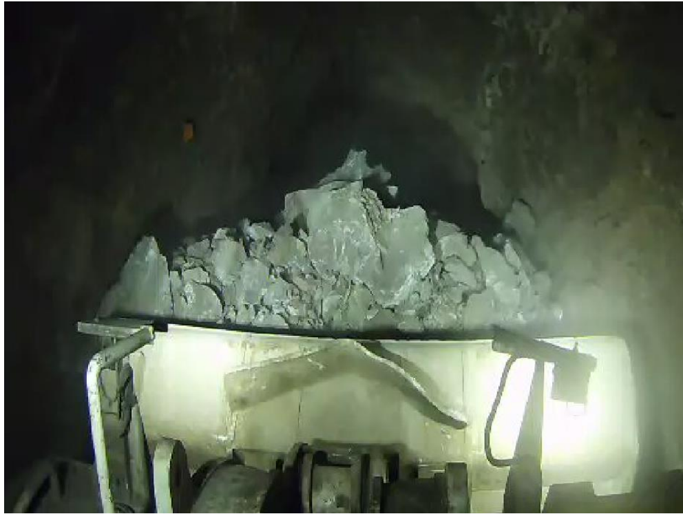
FIGURA 17: BALDE CARGADO RESULTANTE DE UNA CARGA AUTÓNOMA EN PUNTO DE ACOPIO.
