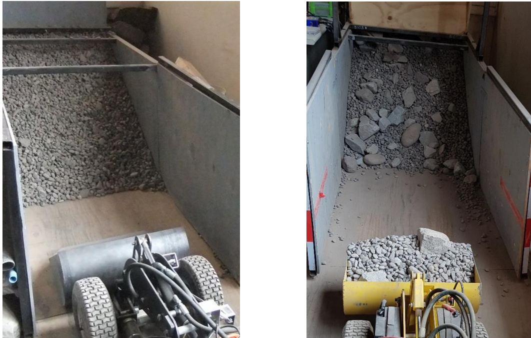
FIGURA 3: PUNTO DE EXTRACCIÓN A ESCALA CON GRANULOMETRÍAS HOMOGÉNEA (IZQUIERDA) Y HETEROGÉNEA (DERECHA).
