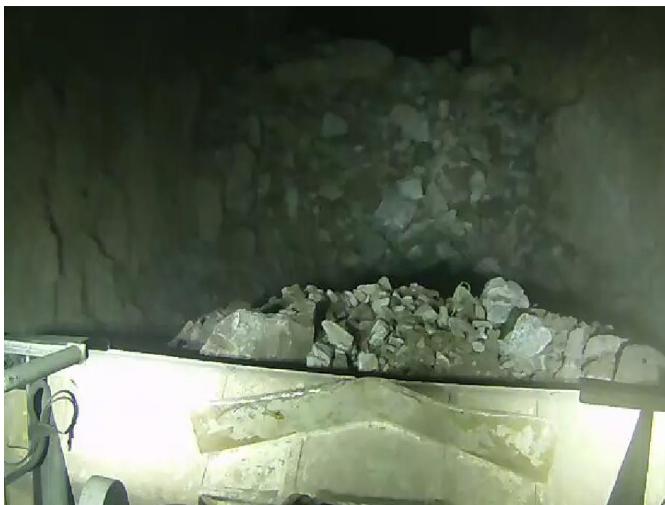
FIGURA 19: BALDE CARGADO RESULTANTE DE UNA CARGA MANUAL EN PUNTO DE ACOPIO.
