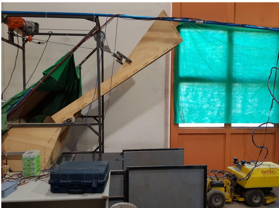
FIGURA 4: RAMPA CONSTRUIDA SOBRE PUNTO DE EXTRACCIÓN PARA CIRCULAR MATERIAL EXTRAÍDO.
