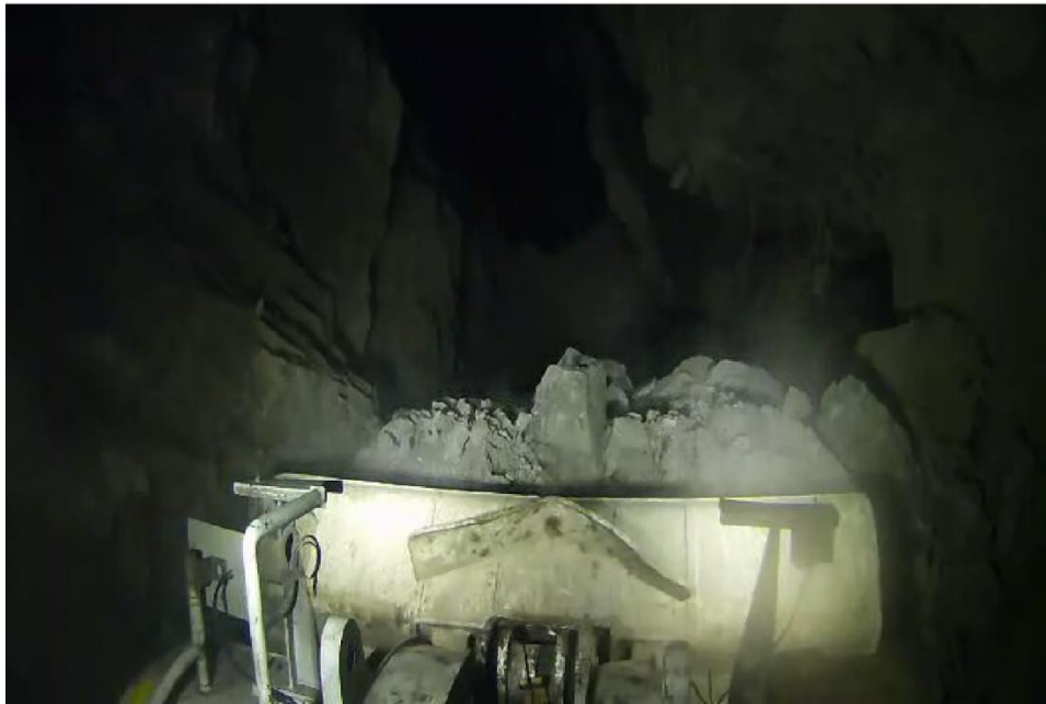
FIGURA 23: BALDE CARGADO RESULTANTE DE UNA CARGA TELEOPERADA CON LÍNEA DE VISTA EN CASERÓN.
