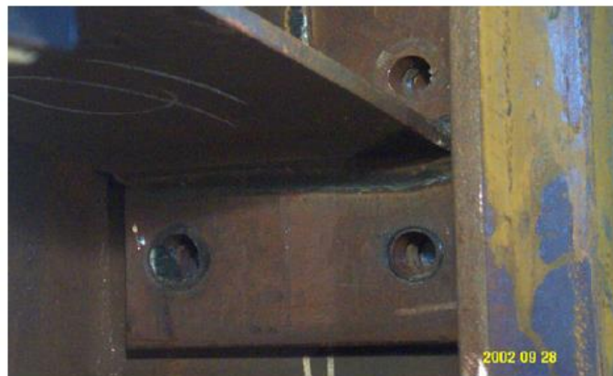
Imagen 2.14: Falla identificada producto de fuerzas de apalancamiento (S. D. Kim et al., 2007)
