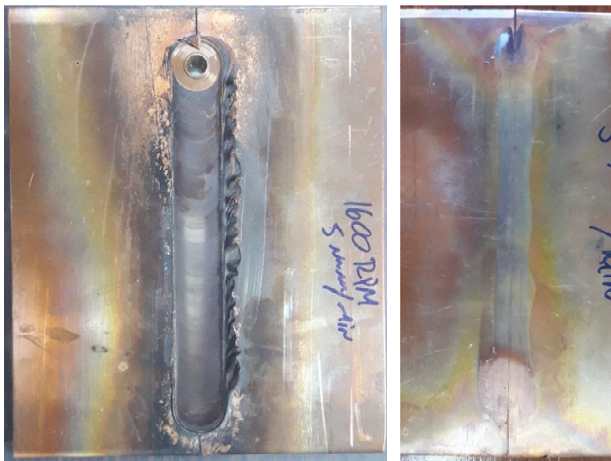
Figura 21: Cordón de soldadura P3, 5 mm/min 1600RPM
