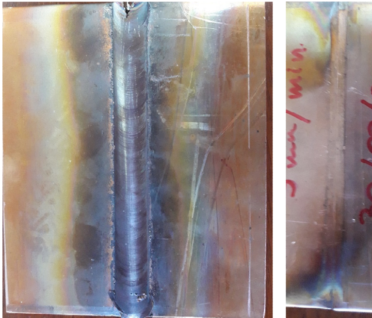
Figura 19: Cordón de soldadura P1, 5 mm/min 800 RPM
