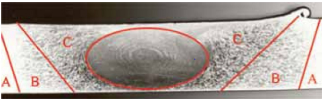
Figura 5: Zonas características en FSW, sección transversal, para aleación 2024 Aluminio
