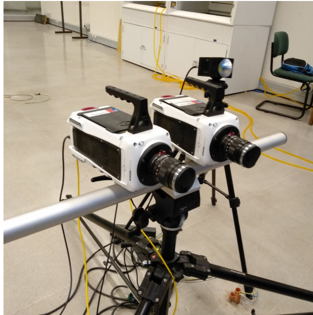
Figura 2.7: Sistema de cámaras, para la obtención de imágenes y su posterior correlación digital, (sistema DIC)
