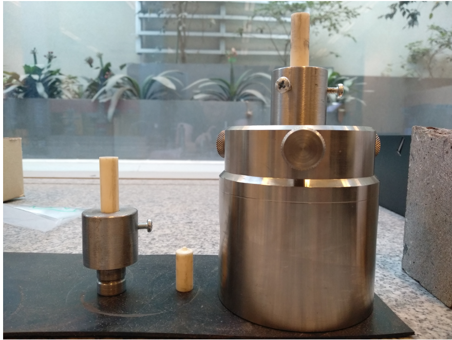
Figura 2.5: Indentador circular plano(izquierda) y barra (derecha), ambos en alumina
