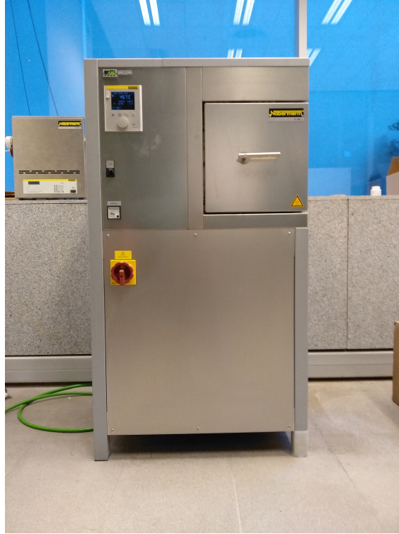
Figura 2.3: Horno Nabertherm ocupado para realizar los tratamientos térmicos de sinterizado y recocido
