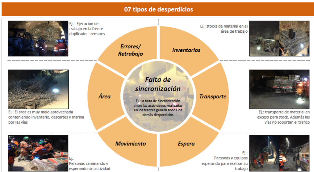
Ilustración 7.1.3-3 Identificación de los tipos de desperdicio definidos en el Toyota Production System en actividades de desarrollo de mina subterránea División El Teniente.
