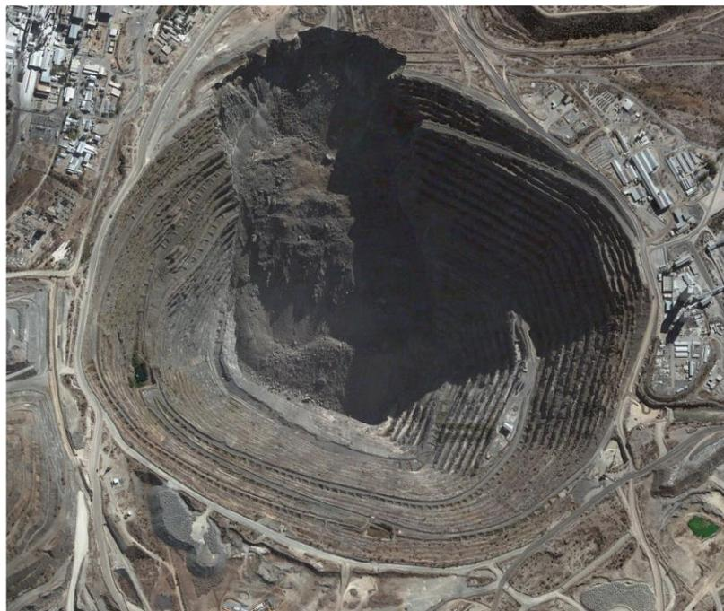
Figura 1.2: Efecto de la subsidencia en un talud de la Mina Palabora, Sudáfrica. Ahmed, Eberhardt, & Dunbar (2014).
