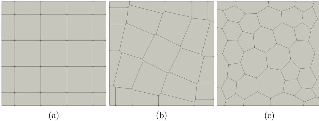
Figura 5.2: Distribuciones de nodos utilizadas en el test de la parcela basado en equilibrio: (a) distribución nodal regular, (b) distribución nodal distorsionada, y (c) distribución nodal no estructurada.
