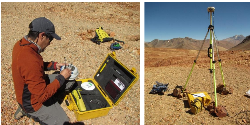
Figura 16. Instalación de Antena GNSS base. Izquierda: preparación del receptor móvil. Derecha: instalación de la antena receptora base.
