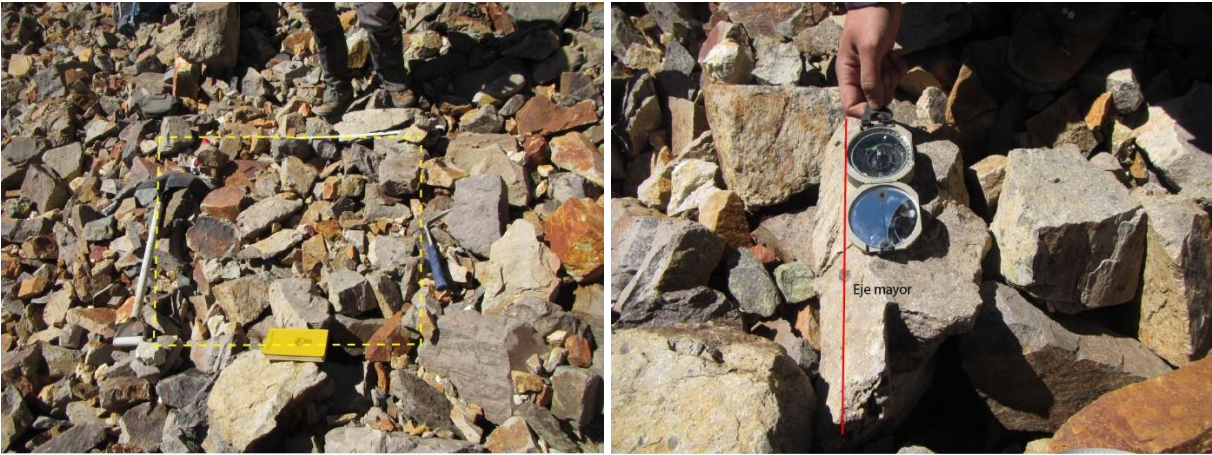
Figura 13. a) La línea discontinua en amarillo muestra el área aproximada de 1 m 2 seleccionada para hacer el muestreo litológico. b) Medición de rumbo de los clastos con respecto a su eje mayor.
