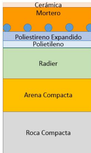
Figura 4.16: Elementos piso radiante. Elaboración propia.
