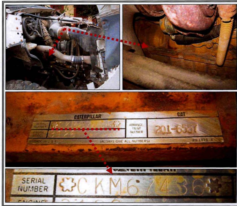
Imagen muestra la placa con la serie de motor y su ubicación
