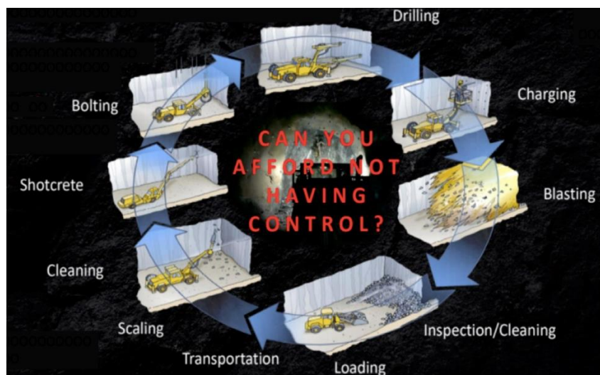
Figura 2-7 Ciclo de perforación y tronadura convencional.
