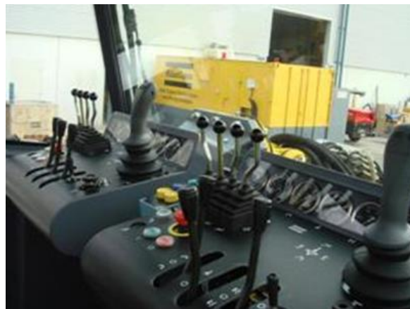
Figura 2-11 Sistema DCS de un Boomer 282. Epiroc.
