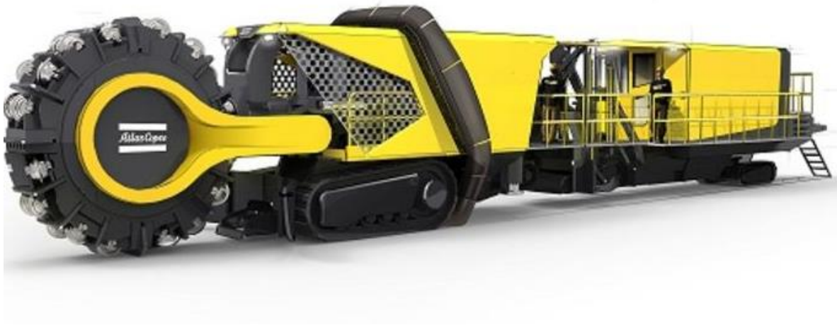
Figura 2-6 Mobile Miner, Tunelera de Epiroc.
