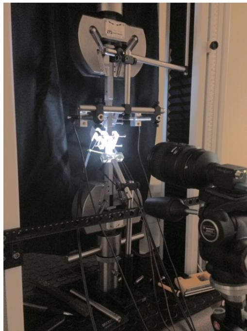
Figura 5.3: Fotografía del montaje para ensayos de tracción y medición de parámetros acústicos.
