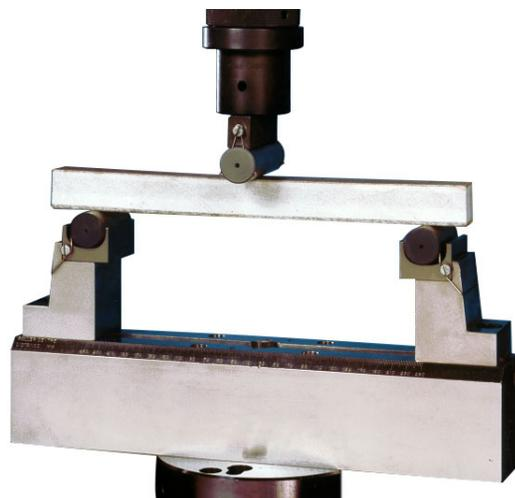
Figura 4.2: Fotografía de una máquina de ensayos de flexión de tres puntas. El pivote central corresponde al punto de carga, mientras los laterales son los soportes de la barra.
