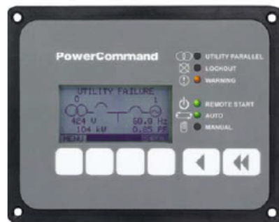
Figura 3.26: Interfase amigable de interacción con el controlador [16]
