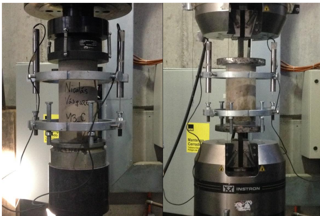
Figura 3.8 Probetas montadas listas para ser ensayadas a compresión (izq.) y tracción (der.) con anillos y LVDTs a los costados.
