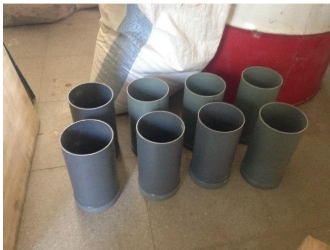
Figura 3.2 Moldes de PVC sellados con silicona.
