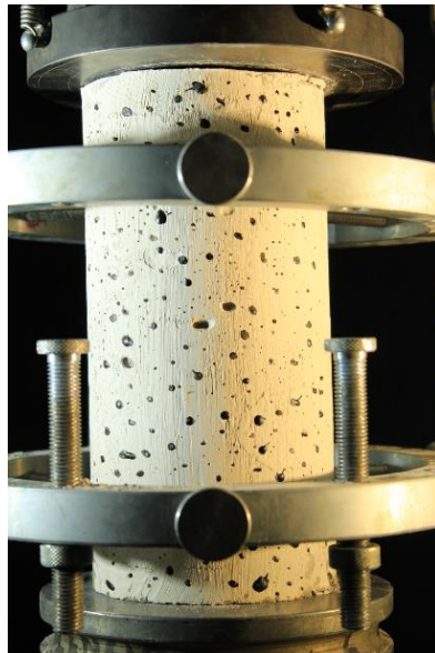
Figura 3.17 Patrón de pintura para fotogrametría.
