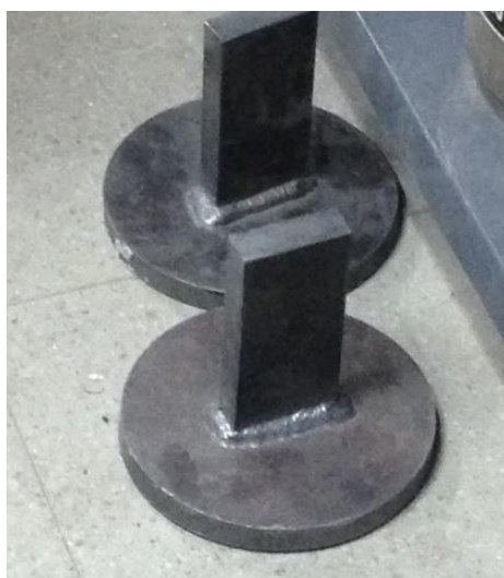
Figura 3.7 Placas de acero utilizadas para probetas destinadas a tracción.
