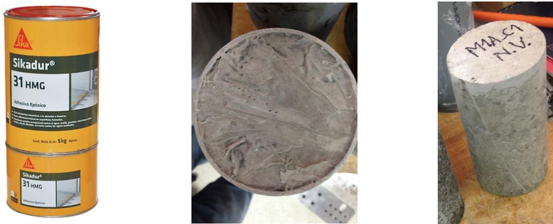
Figura 3.6 Sikadur y superficie de probeta pre y post refrentado.
