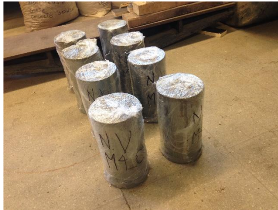
Figura 3.5 Curado del hormigón.
