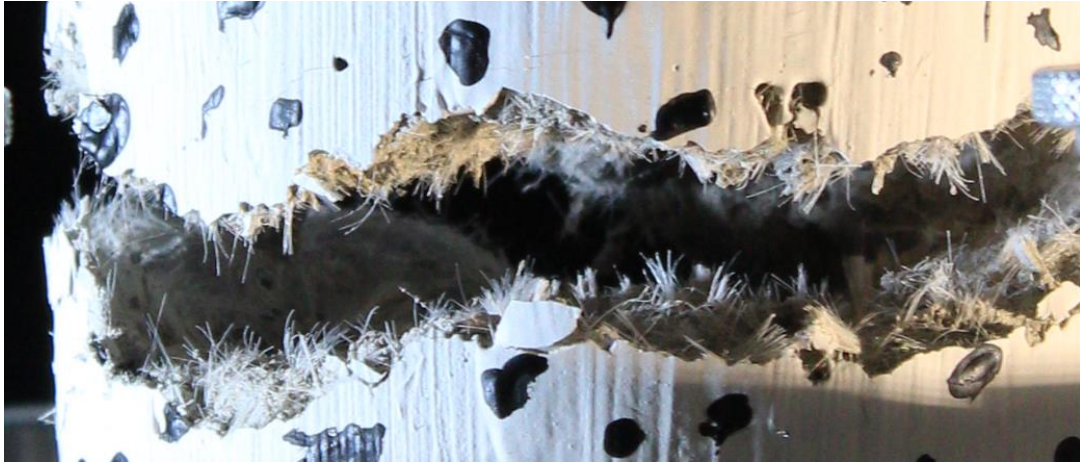
Figura 3.23 Fisura completamente abierta a tracción que presenta la distribución y orientación del PVA.
