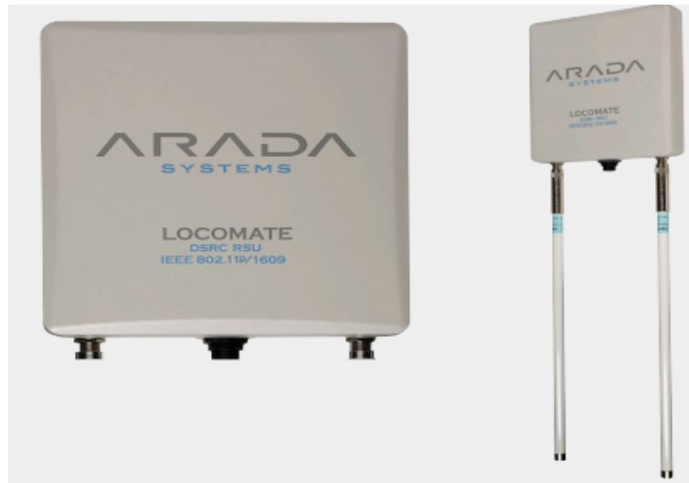
Figura 2.4: Ejemplo de equipo comercial utilizado como RSU, Locomate RSU, (fuente: [6]).
