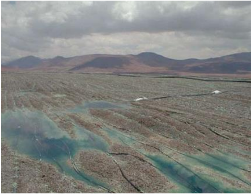
Figura 10: Anegamientos provocados por exceso de riego, mala calidad del glómero y exceso de finos.
