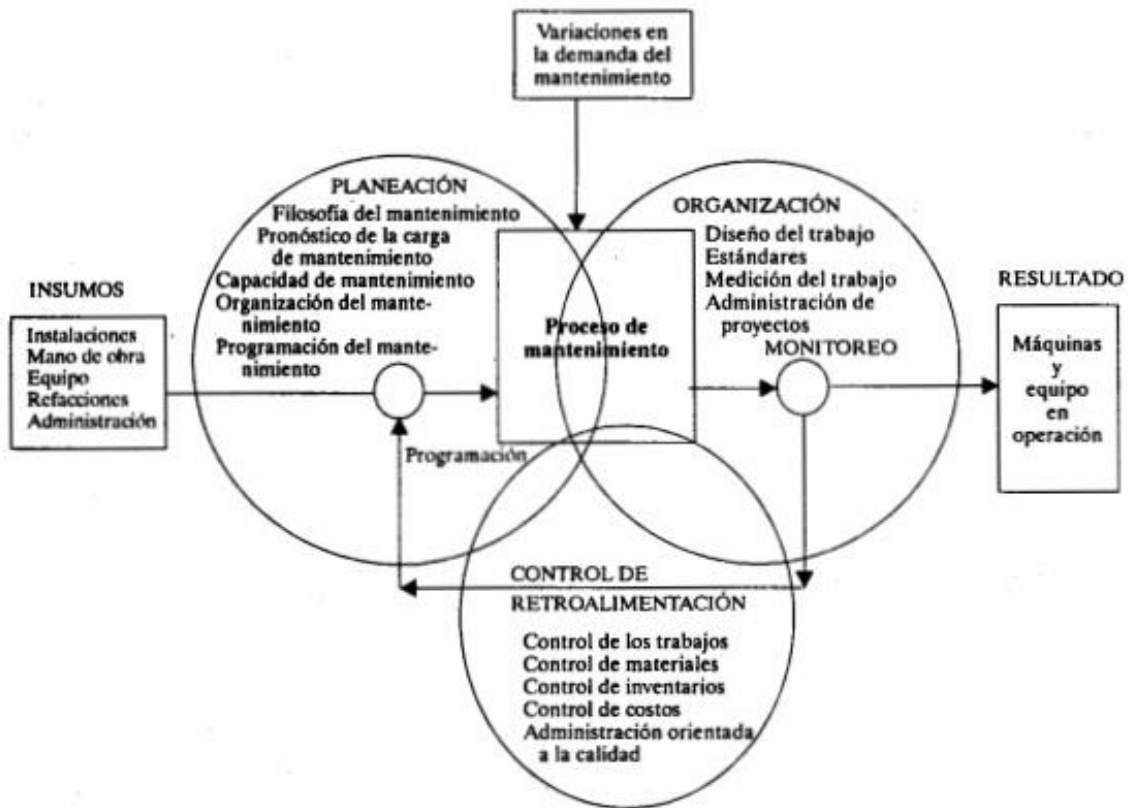
Ilustración N°9: Sistema de mantenimiento
