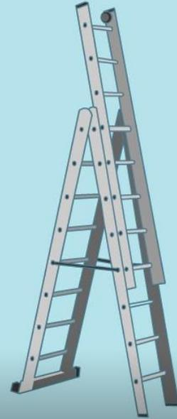
*Ilustración 19. Definición escalas transformables. Extracto curso de capacitación para trabajo en altura de la ACHS.*
