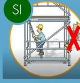
La altura no debe exceder 4 veces el lado menor de la base en interiores y de 3 veces en exteriores.
