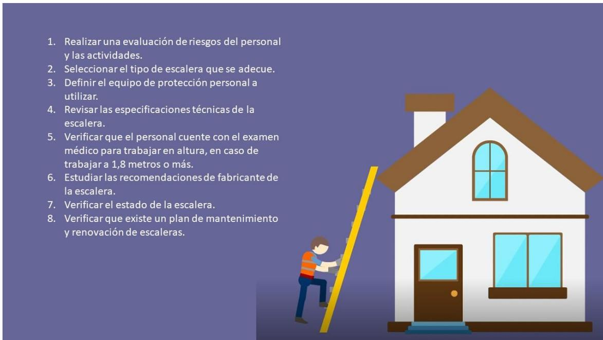
Ilustración 26. Planificación trabajo en escaleras. Elaboración propia, material gráfico ACHS.
