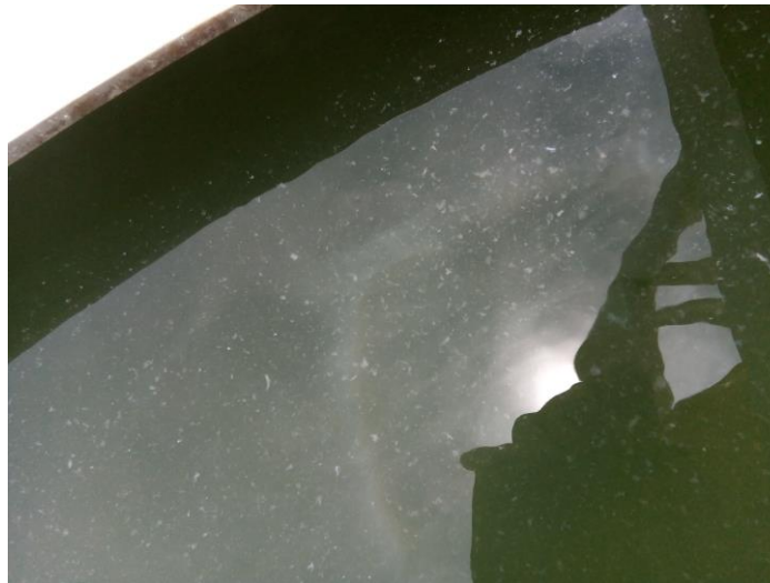
Figura 36: Fibras largas en el agua superclarificada, dirigida hacia el tanque TQ-336 (situación con equipos fuera de servicio).
