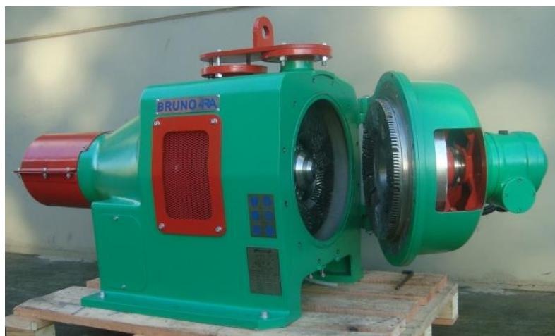
Figura 9: Refinador usado para la fabricación de papel [12].
