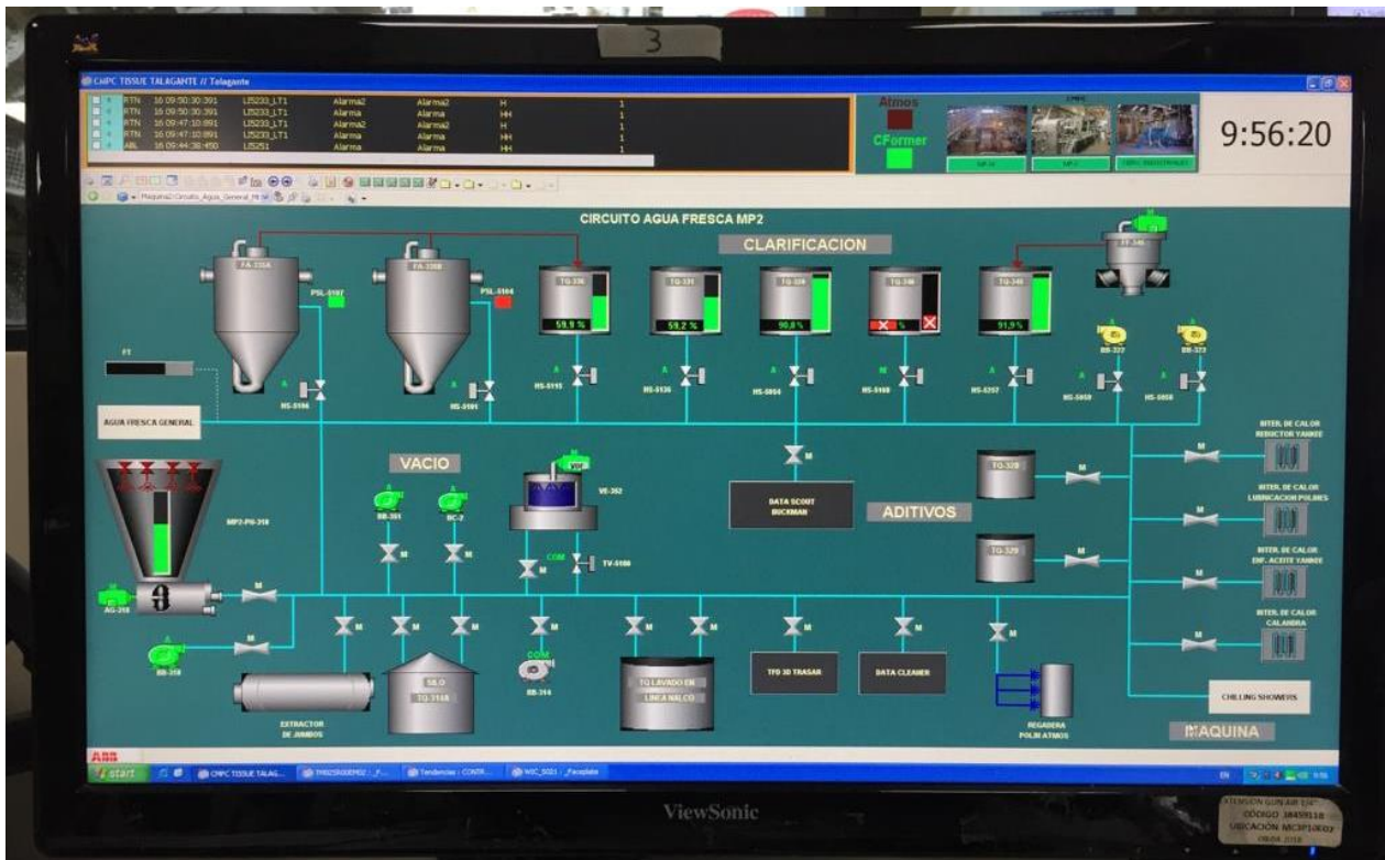
Figura 58: Imagen parcial de la implementación del diagrama de agua industrial en la MP1 en las pantallas del DCS.
