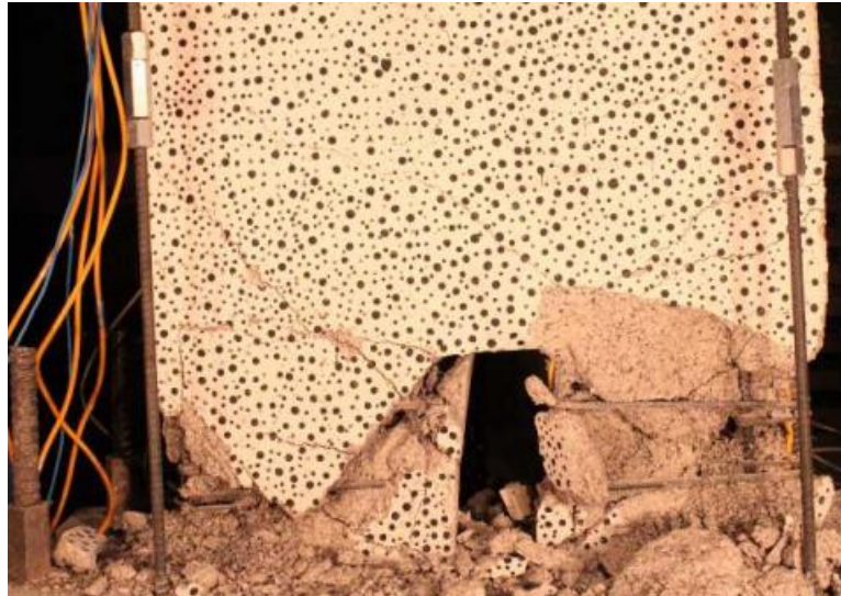
Figura 25: Estado de la probeta al término del ensayo experimental.
