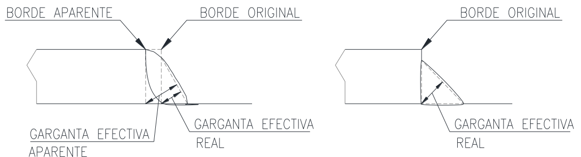
Figura 6-1: Garganta efectiva para soldadura de filete
