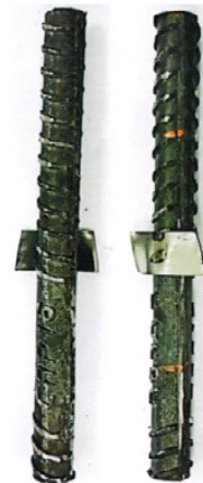
Figura 2: Probeta de barra soldada al fleje
