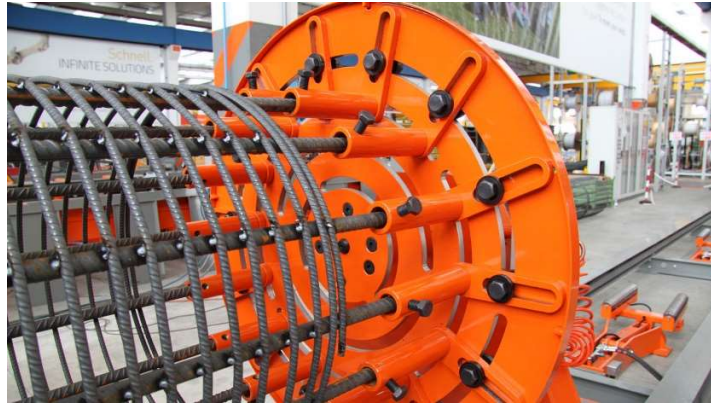
Figura 3: Armadura de refuerzo soldada para pilote
