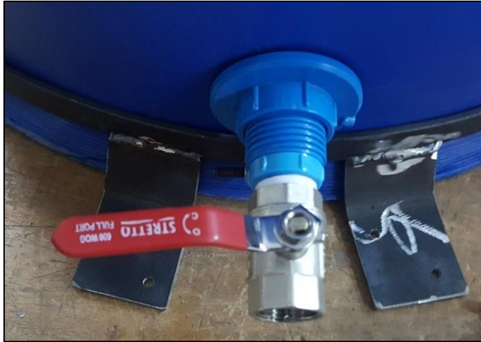
Figura 5.4. Válvula de salida de estanque principal.
