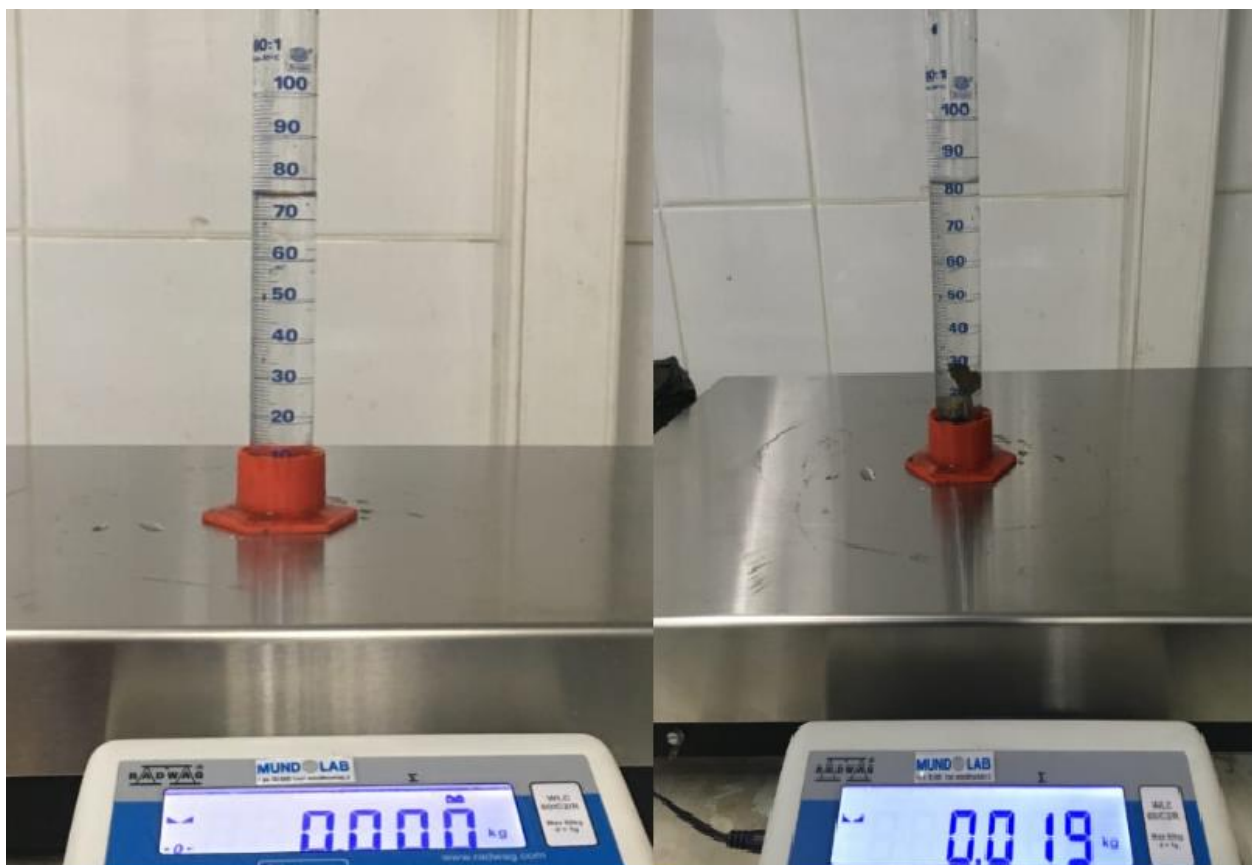
Figura 4.1: Ensayo para el cálculo de la densidad del material. [Elaboración propia]
