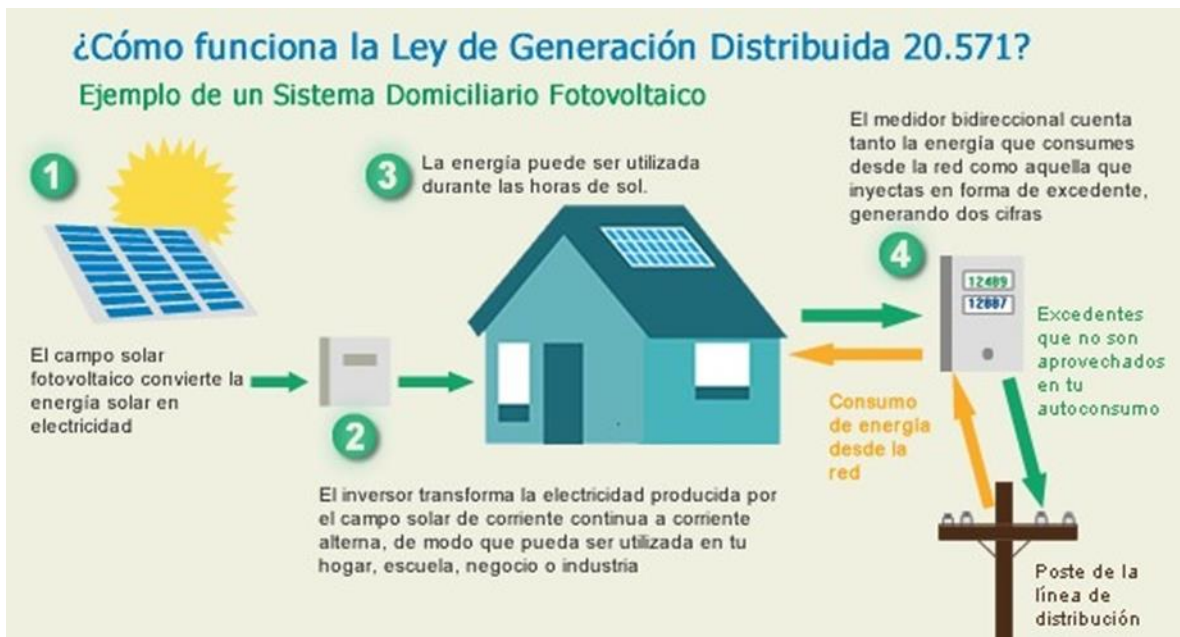
Ilustración 11. Esquema de funcionamiento de un sistema fotovoltaico conectado a la red de acuerdo a la ley net-billing (SEC, 2018)
