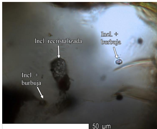
Figura 9.38: Microfotografía a luz reflejada a un conjunto de inclusiones, con la central y más grande estando recristalizada. La más pequeña, en la parte inferior de la imagen está en otro plano y no se alcanza a distinguir la burbuja, pero es similar a la superior derecha.
