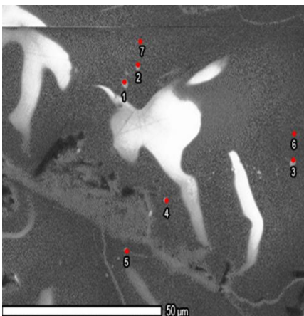
Figura y tabla B. 3: Microfotografía mediante SEM de los puntos de medición en Sitio 3 junto a las abundancias elementales obtenidas mediante EDS en DM053 A1
