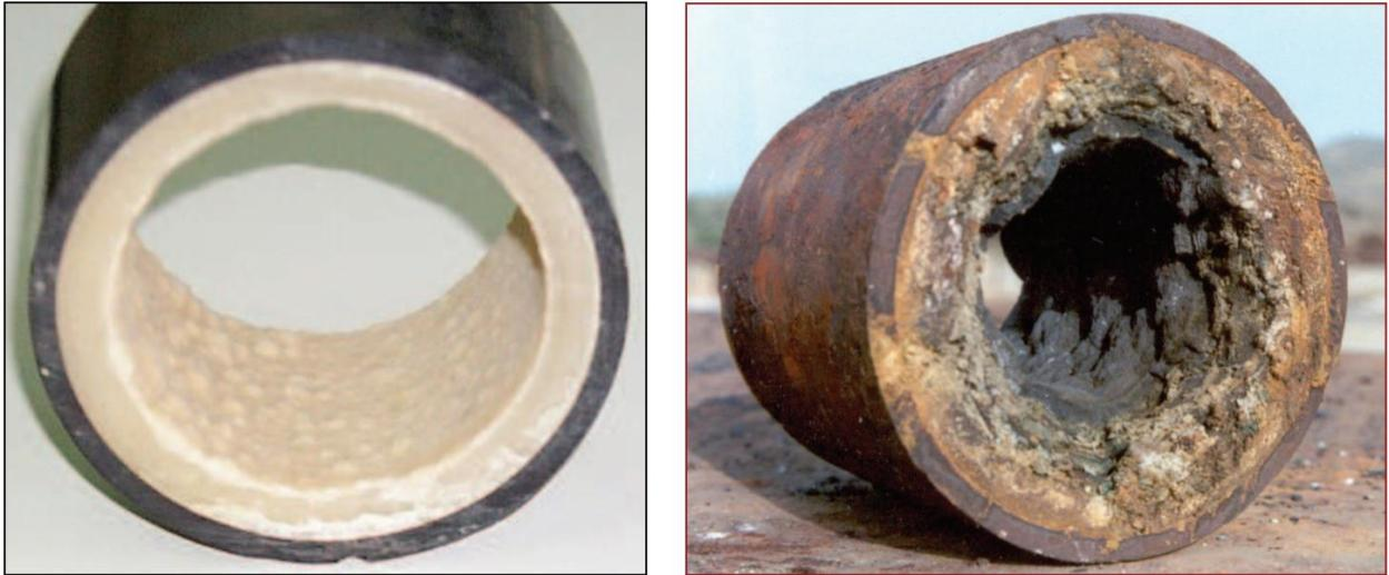
Figura 2: Imágenes de scaling en tuberías geotérmicas. A la izquierda, precipitados de CaCO<sub>3</sub> en una tubería que transporta agua geotérmica de baja entalpía en Nigrita, Grecia. A la derecha, precipitados mixtos de sílice y sulfuro en la tubería de reinyección de la planta geotérmica de Milos, Grecia. (Andritsos et al., 2002).
