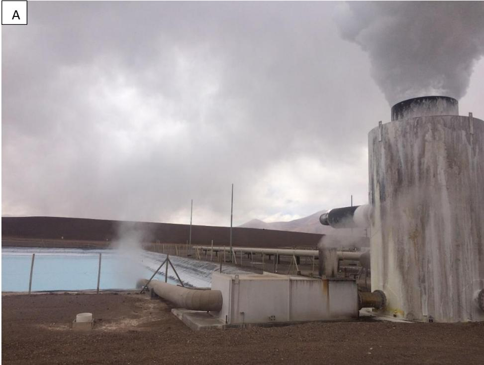
Figura 18a: Fotografía de pozo de producción CP-5A durante una prueba al separador atmosférico..
