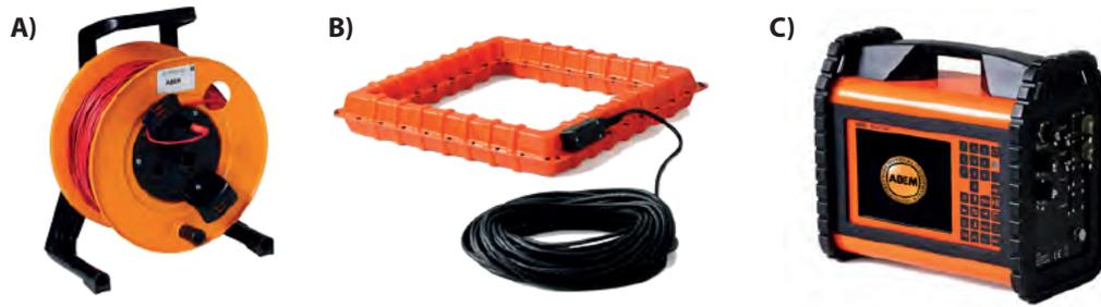
Figura 4.2: Distintas partes del equipo WalkTEM de ABEM. A) Carrete de 160 m de cable para generar loop transmisor de 40 x 40 m. B) Antena receptora de 0.5 x 0.5  $m^2$ , con un área efectiva de 5  $m^2$ . C) Consola de adquisición de datos.
