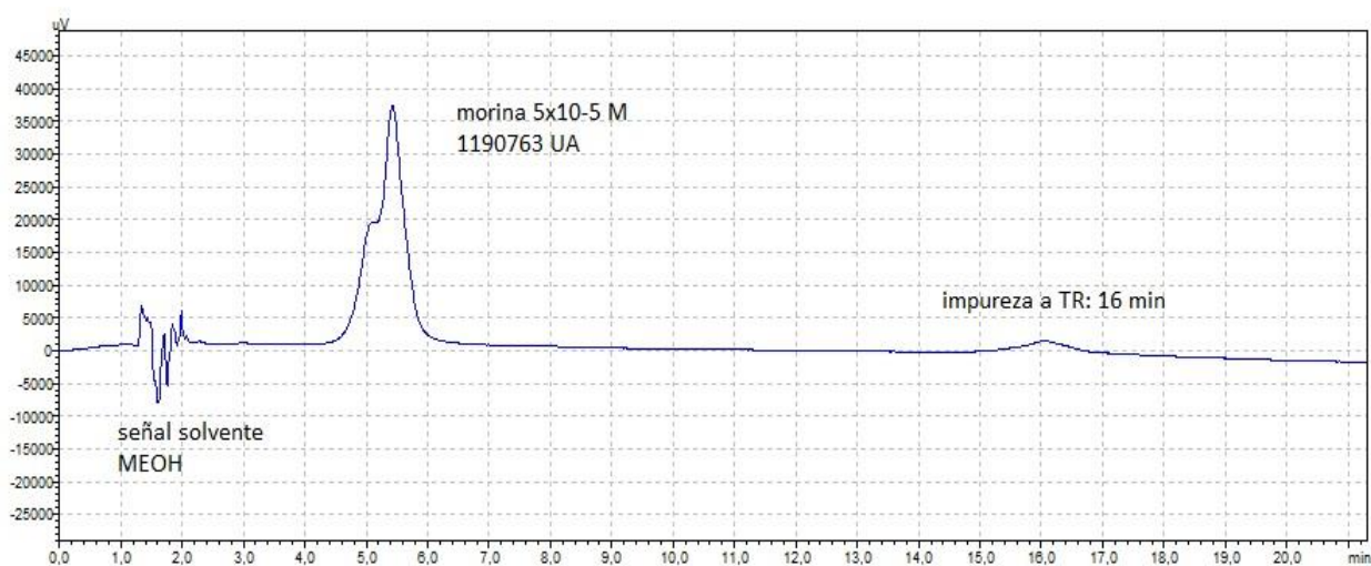
Figura 7. Cromatograma de HPLC para el compuesto morina usando metodología de análisis columna C18 CHROMOLITH®
