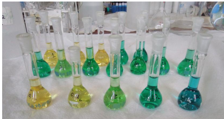
Figura 8: Coloración curva de calibración (frente) y muestras (fondo) para determinación de Amonio.
