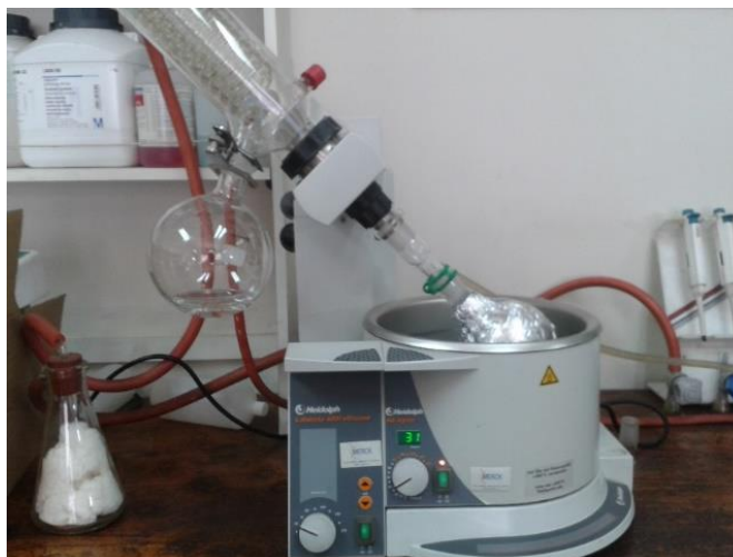
Figura 7: Incorporación de los analitos al biosólido por homogenización en rotavapor.
