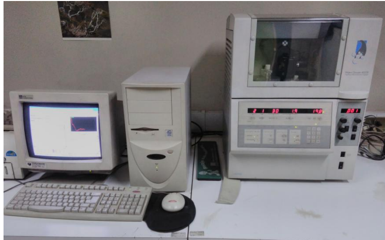
Figura 9: Equipo de Electroforesis capilar utilizado en la determinación de Nitrato.
