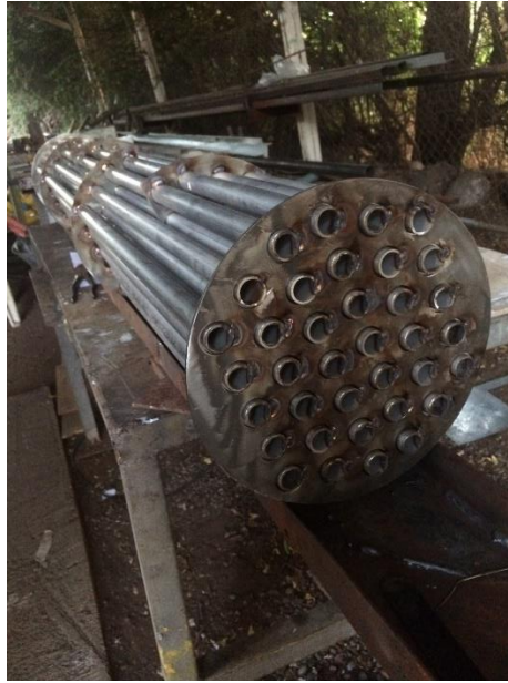
Figura 10.16 Haz de tubos ITC. Fuente: Elaboración propia.
