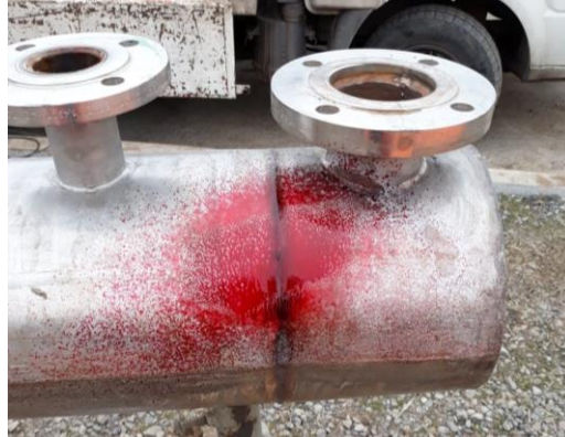
Figura 10.54 Ensayo de tintas penetrantes. Fuente: Elaboración propia.
