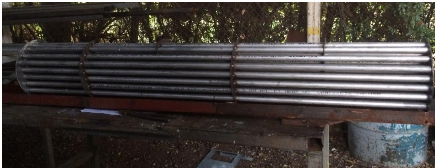
Figura 10.17 Haz de tubos ITC. Fuente: Elaboración propia.
