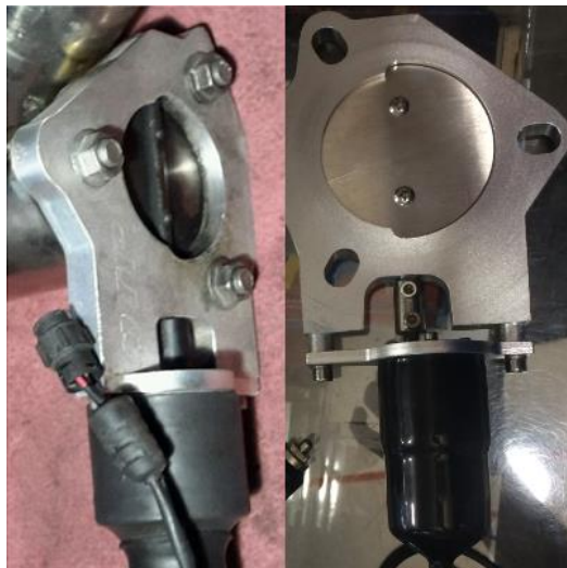
Figura 10.61 Válvulas Cut – Out. Fuente: Elaboración propia.
