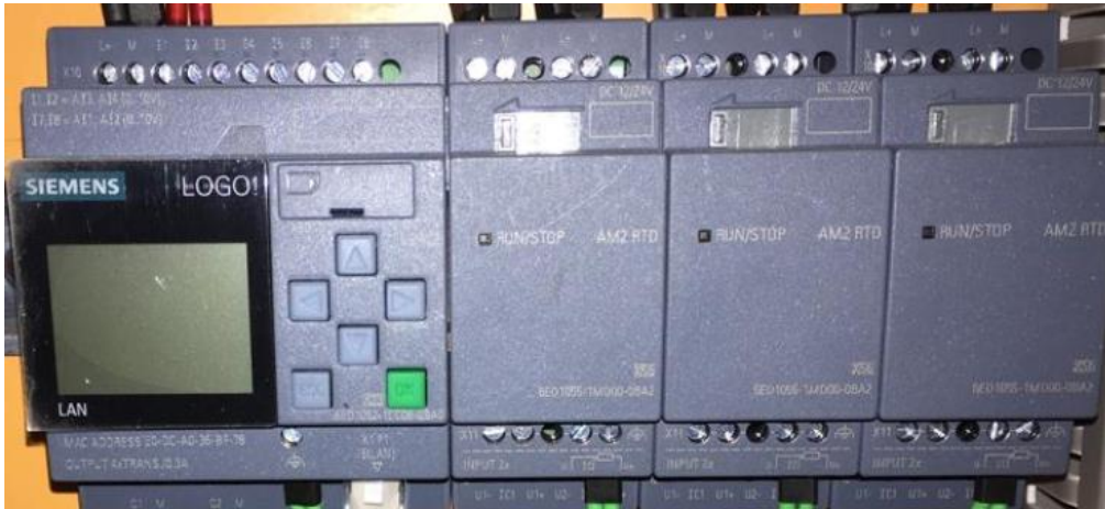
Figura 10.14 PLC seleccionado. Fuente: Elaboración propia.
