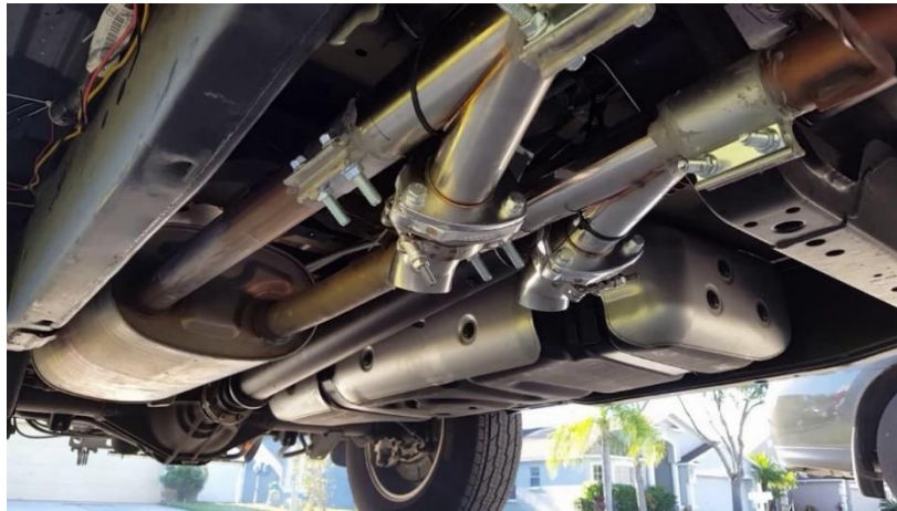
Figura 10.12 Montaje válvula Cut - Out. Fuente: [26].
