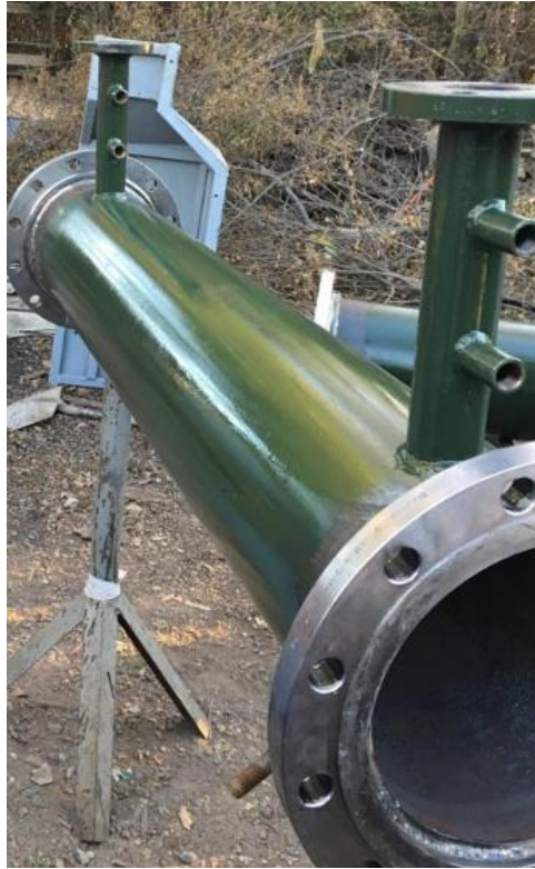
Figura 10.63 Carcasa de intercambiador. Fuente: Elaboración propia.
