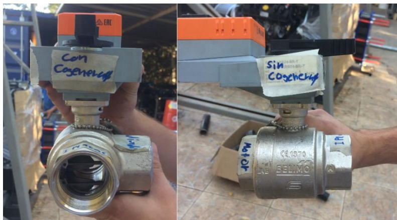
Figura 10.22 Válvula de tres vías. Fuente: Elaboración propia.
