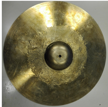
(a) Vista superior primera fase de martillado
