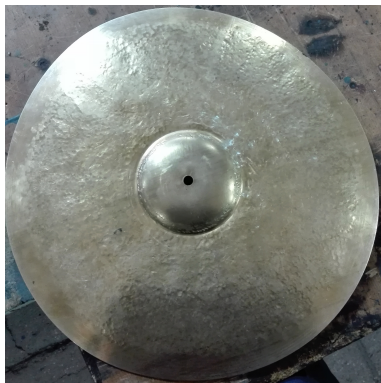
(c) Vista superior segunda fase de martillado
