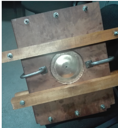
Figura 2.6: Sistema de pretensión.
