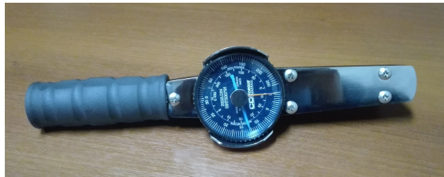
Figura 2.7: Llave de torque CDI modelo 2502ldin
