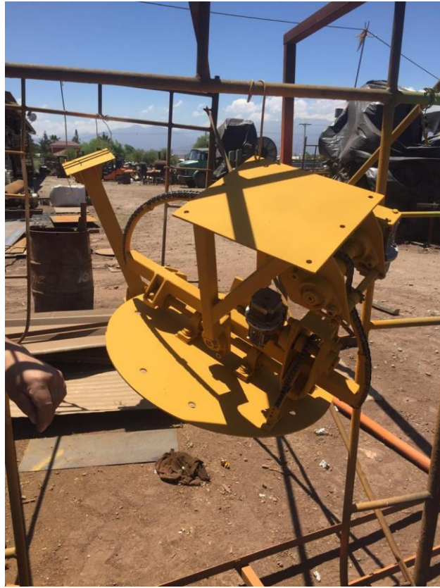
Figura 40: Etapa de aplicación de pintura anticorrosiva Prototipo 2.0.
