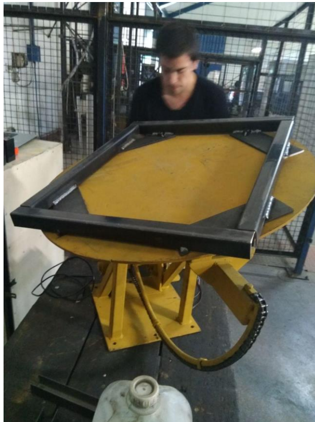
Figura 42: Fabricación e instalación de marco para espejo de 1[m 2 ] para Prototipo 2.0.
