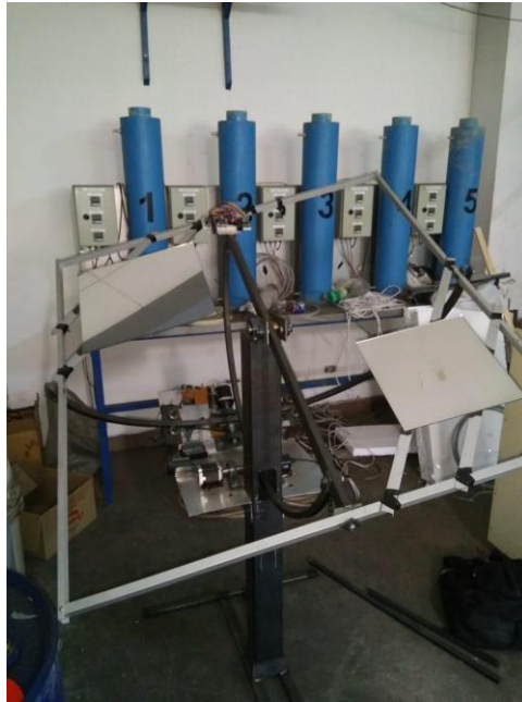
Figura 31: Instalación de espejos para pruebas en exterior Prototipo 1.0.
