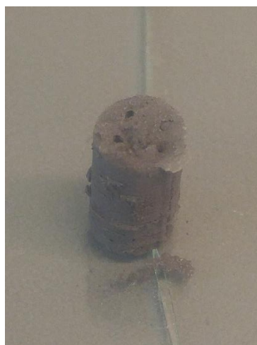
Ilustración 20 - Monolito CTO/Ni:HPMC 96% peso. Secado 2 días a T° ambiente y 3 días a 50 °C. Calcinado a 600 °C por 10 min.
