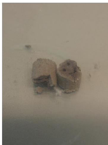
Ilustración 18 - Monolito CTO/Ni:Silicato de sodio 75% peso. Calcinado a 250 °C por 1 h y a 600 °C por 8 h secado medio.
