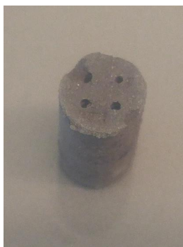
Ilustración 21 - CTO/Ni:MC 96% secado 2 días a T° ambiente y 3 días a 50 °C. Calcinado a 600 °C por 10 min.
