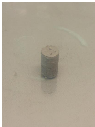
Ilustración 19 - Monolito CTO/Ni:Silicato de sodio 75% peso. Calcinado a 250 °C por 10 h y a 600 °C por 8 h. Secado lento.
