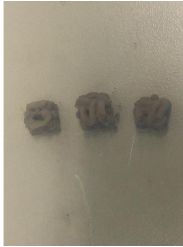
Ilustración 25 -Monolitos fabricados por extrusión convencional. 96% CTO/Ni:HPMC calcinados a 600 °C por 1 h.
