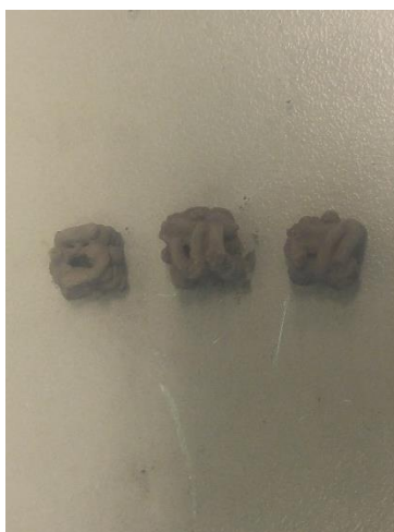
Ilustración 10 -Monolitos fabricados por extrusión convencional. 96% CTO/Ni:HPMC calcinados a 600 °C por 1 h.
