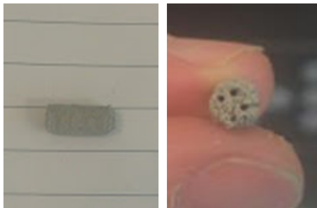
Ilustración 12 - Monolito CTO/Ni : Silicato de sodio 50% peso. Calcinado a 600 °C por 8 h.
