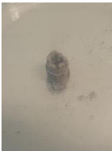
Ilustración 17 - Monolito CTO/Ni:HPMC:Silicato de sodio 85% peso. Molde A calcinado a 600 °C por 8 h.
