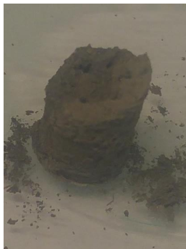
Ilustración 16 - Monolito CTO/Ni:HPMC:Silicato de sodio 75% peso. Molde A calcinado a 600 °C por 8 h.
