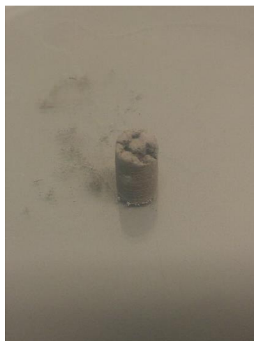
Ilustración 22 - Monolito CTO/Ni:HPMC:Silicato de sodio 75% peso. Calcinado a 600 °C por 8 h. Secado lento.
