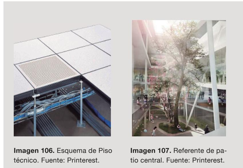
**Imagen 106.** Esquema de Piso técnico. Fuente: Printerest.
